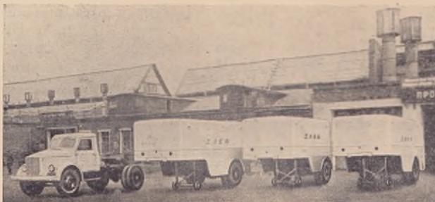
Рис. 1. Автомобиль-тягач, выполненный на базе автомобиля ГАЗ-51, и три полуприцепа.
