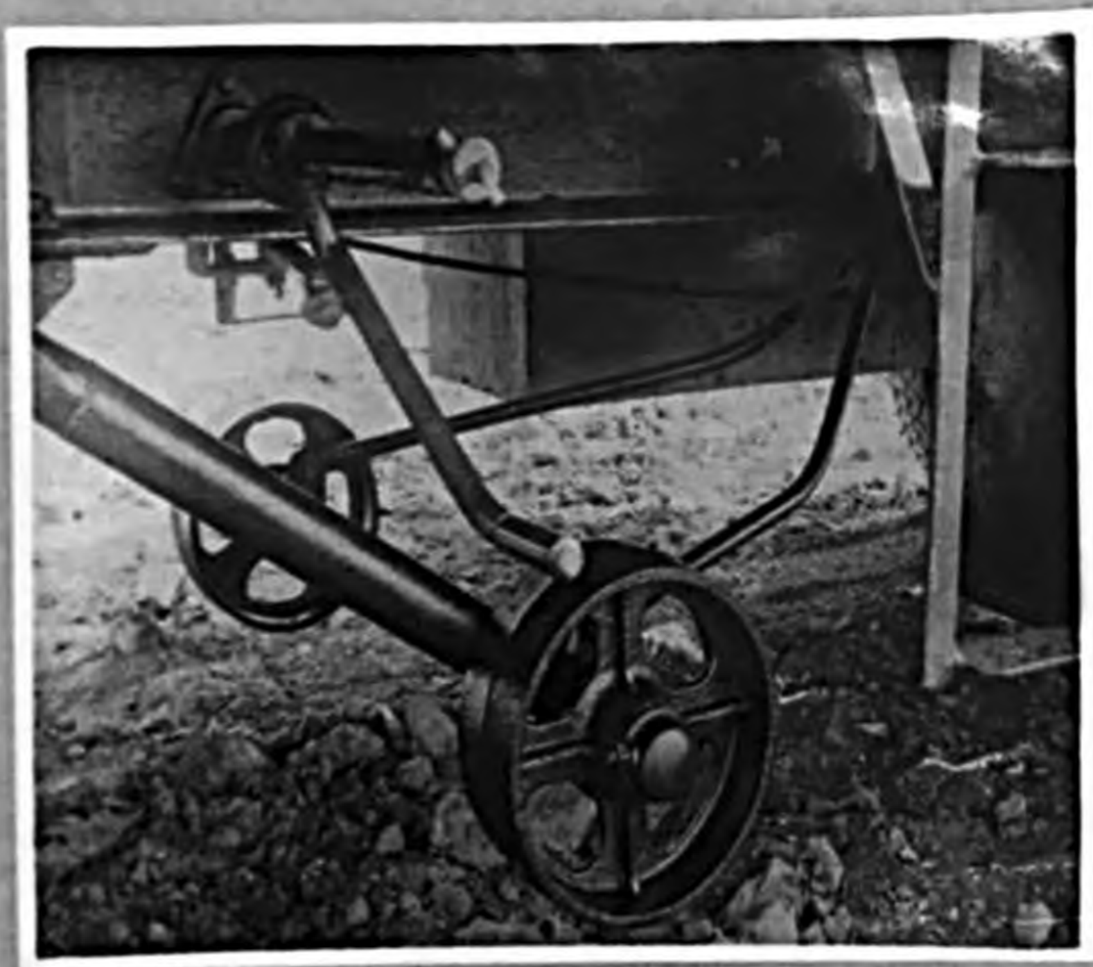
фото № 25. Левый и правый раскос опорных катушек цистерны получили выгиб при движении по разбитым дорогам.
