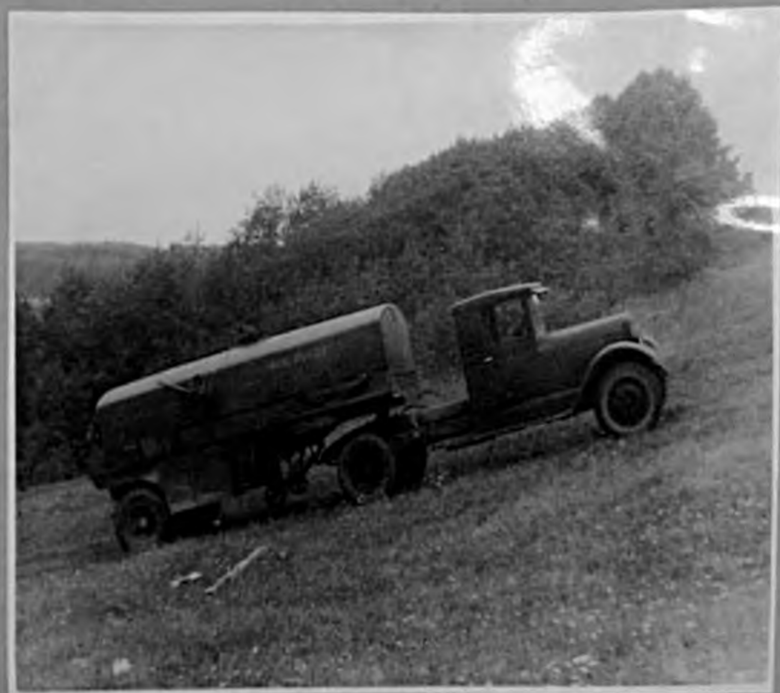
Фото № 15. Бензовоз преодолевает подъем в 10^{\circ} , длиной 60 метр. на 1-й передаче. Подъем преодолел.
