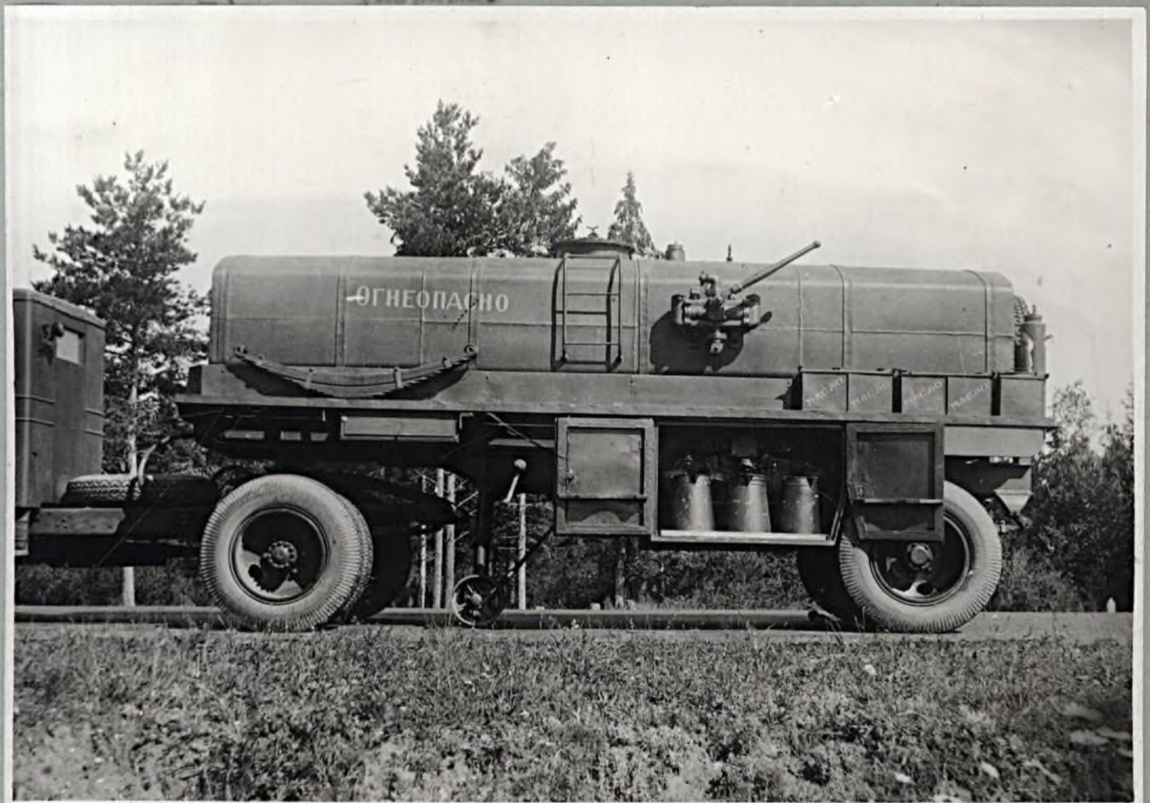
Фото № 8. Бензовоз ЗИС-10 "В-ШН" с раскрытым люком, где видно размещение водер, воронок и раз- даточных кранов.
