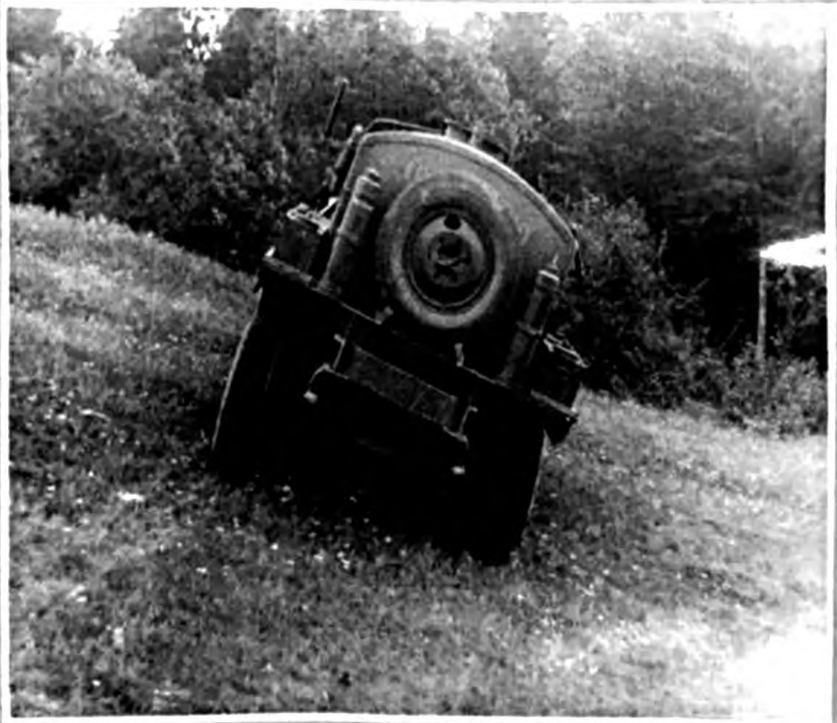
Фото № 17. Бензовоз преодолевает крен в 13^{\circ} . Крен преодолен.
