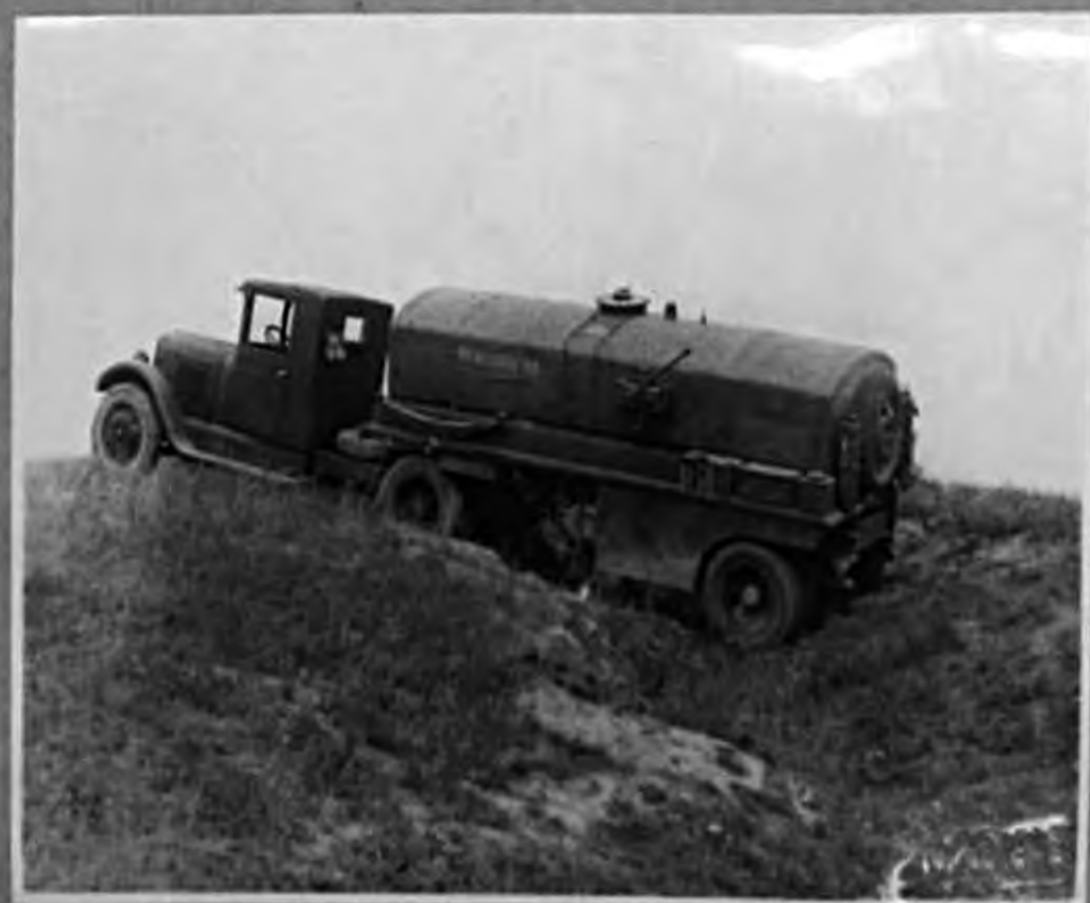
Фото № 19. Бензовоз преодолевает канаву длинною 2,5 метр. Канаву не преодолел.
