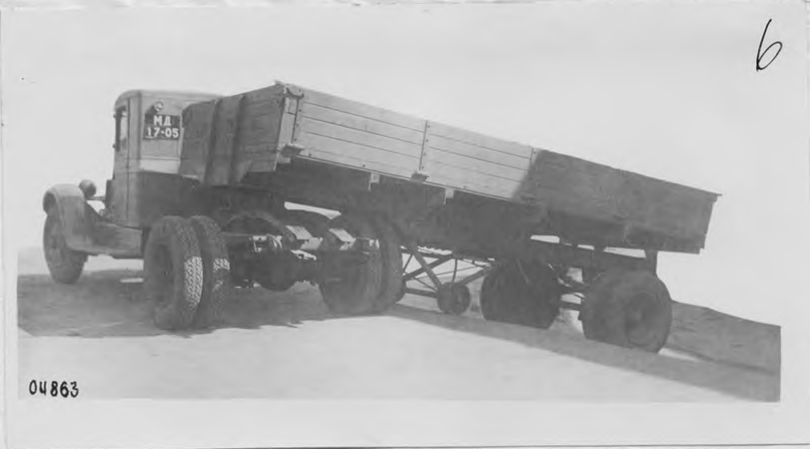
Рис. 5 и 6. Определение кинематических качеств автопоезда. Положение III.
