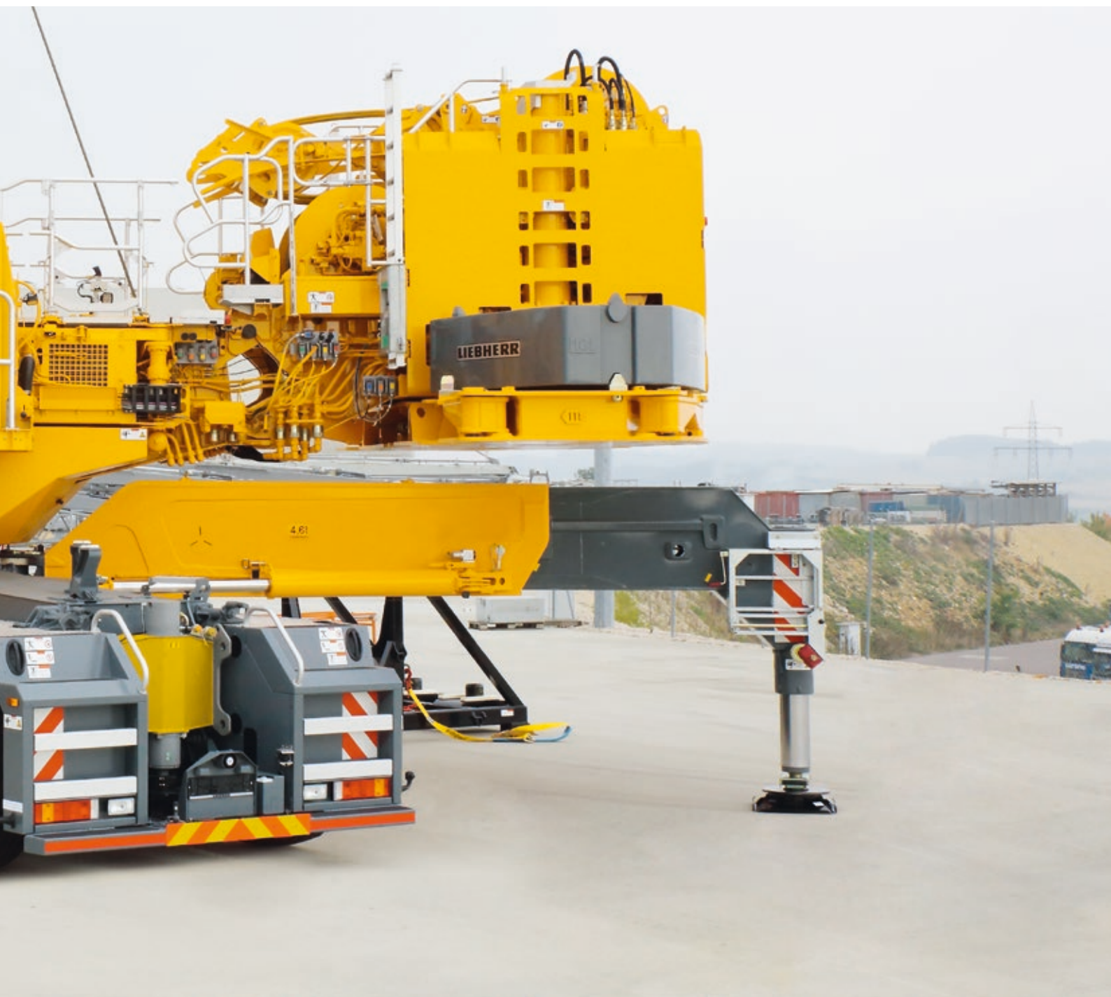
7 Цилиндр рамы противовеса закреплен на основной плите противовеса
