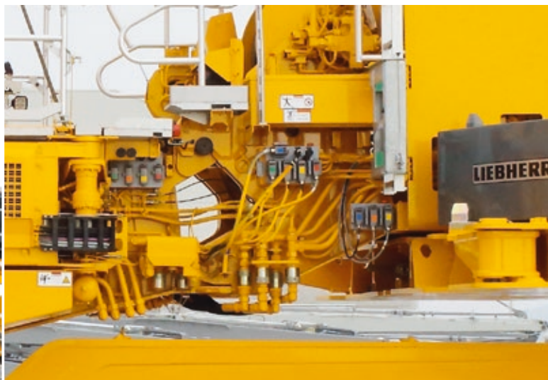
8 Соединить гидравлические и электрические быстросменные муфты
