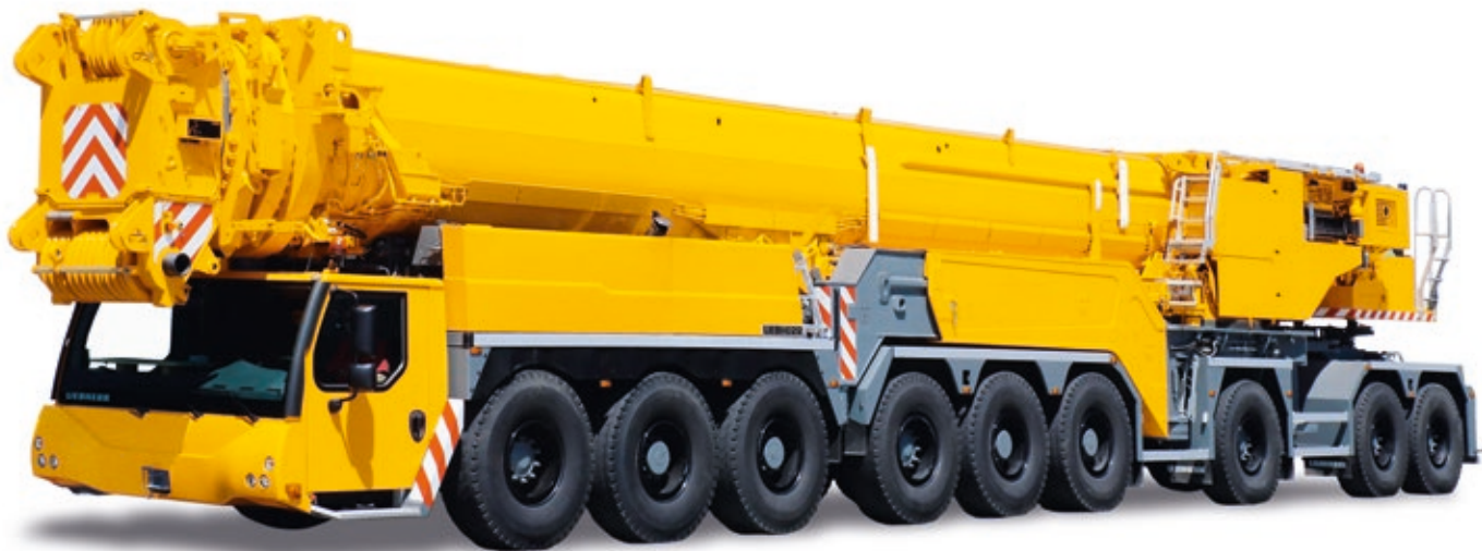
Общий вес крана с передними опорами 108 т, с нагрузкой на ось 12 т
