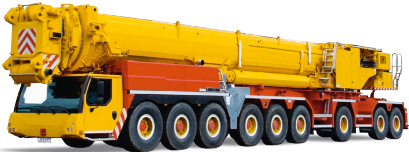
Общий вес крана без опор 99 т, с нагрузкой на ось 11 т
