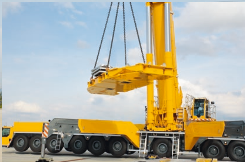
④ Самомонтаж основной плиты противовеса
