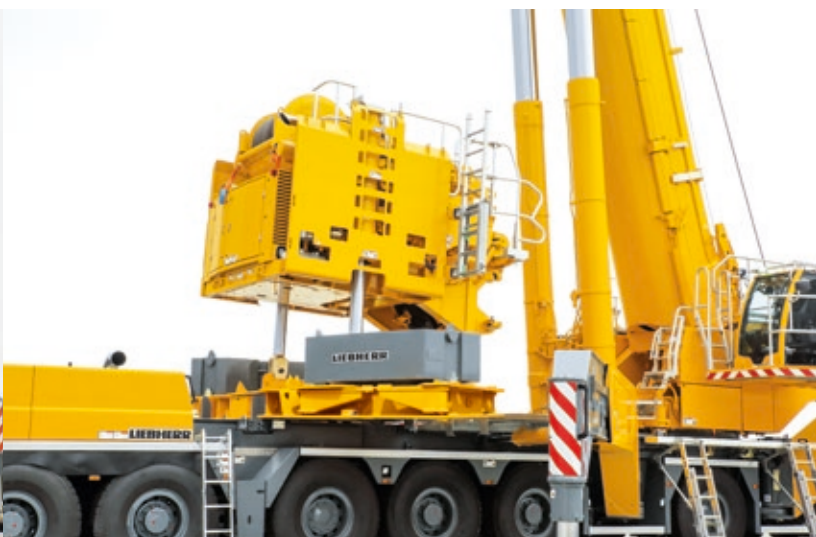
7 Цилиндр рамы противовеса закреплен на основной плите противовеса
