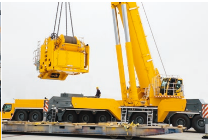
⑥ Самомонтаж рамы противовеса с приводным агрегатом
