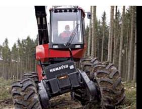
Отличная устойчивость и сцепление с почвой благодаря функции выравнивания кабины и манипулятора, а также гидравлического соединения с качающейся осью.
