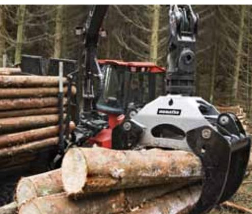
Дополнительно выбрав уникальное оборудование конца стрелы манипулятора ProTeC вы получите дополнительные преимущества: Уменьшение затрат на обслуживания шлангов, более быстрая погрузка/разгрузка и увеличение производительности на целых 5%. Преимущества становятся ещё более очевидными при операции вывозки хвороста и лесосечных отходов.
