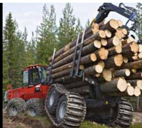
Отличная устойчивость благодаря уникальной конструкции центрального шарнира компании Komatsu. Мощная конструкция, рассчитанная для большого тоннажа, обеспечивает большую грузоподъёмность.
