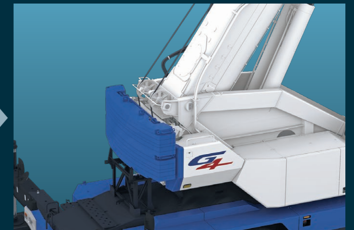
カウンタウエイトを油圧シリンダで引き上げ、旋回体後端に取付。
