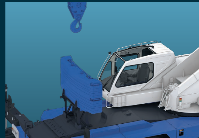
架装サポートをキャリア上に固定し、カウンタウエイトを設置。
