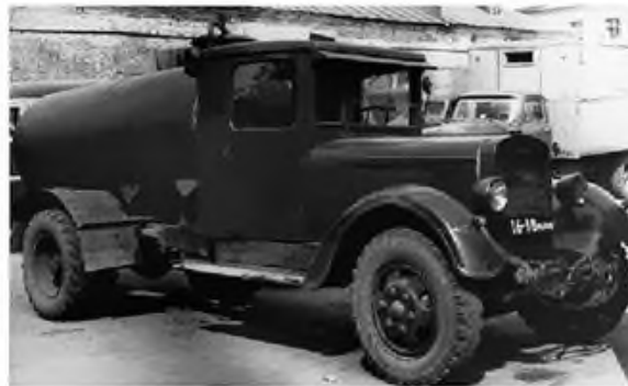
Ассенизационная машина АСМ-3 на шасси ГАЗ-63, она же автомобиль для перевозки глинистого раствора
