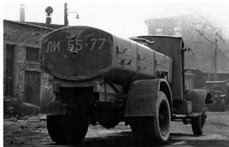
Ассенизационный автомобиль, переделанный из поливочной машины Ленинградским трестом городской очистки. Фото 1939 г.
