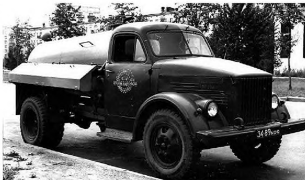
Ассенизационный автомобиль АСМ-51, выпускавшийся с 1970 по 1975 гг.
