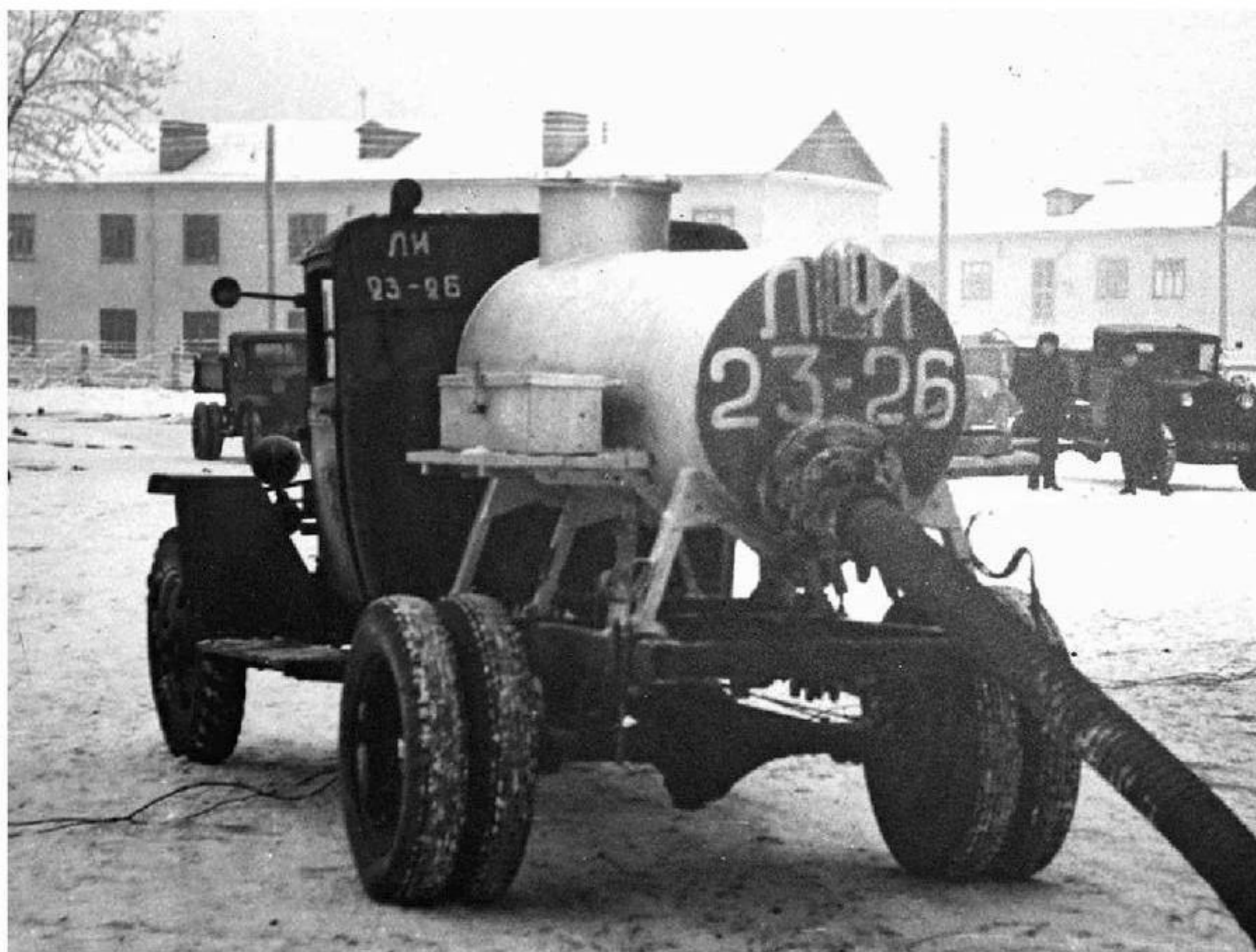
Ассенизационный автомобиль на шасси ГАЗ-ММ отсасывает нечистоты у барачных Ленинградского ГУЛага, фото 1939 г.
