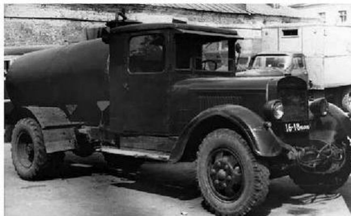
Безнасосный ассенизационный автомобиль АСМ-1 на шасси Урал-ЗИС-355, в конце 60-х обслуживавший подмосковную Купавинскую тонкосуконную фабрику
