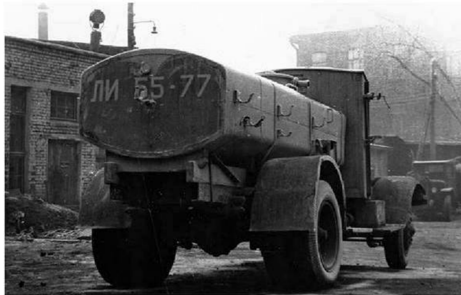
Ассенизационный автомобиль, переделанный из поливочно-моечной машины Ленинградским трестом городской очистки. Фото 1939 г.
