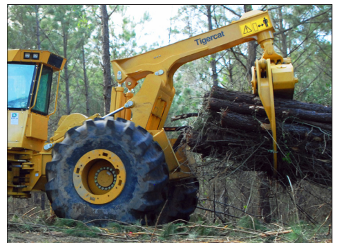
620D является универсальным трелевочным трактором для прореживания плантаций и сплошной рубки.
