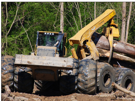
635D с шестиколесным приводом идеально подходит для исключительно тяжелых условий эксплуатации.
