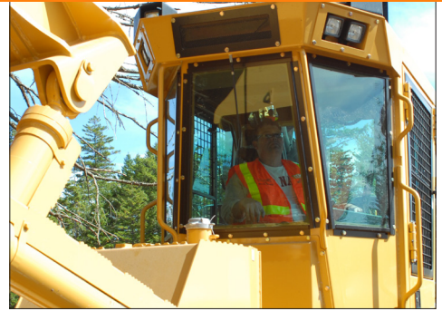
Turnaround обеспечивает полный контроль управления в положении лицом назад для снижения напряженности шеи во время движения захватом вперед, собирания пакета или выполнения штабелирования.
