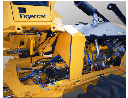
Наклон кабины для доступа к насосам и трансмиссии.
