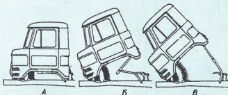
Р и с. 1. Откидывающаяся кабина: а) рабочее положение; б) откидывание началось; в) кабина откинута.
