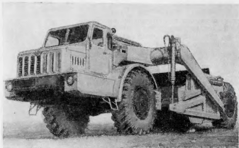
Рис. 1. Одноосный тягач МАЗ-529Е со скрепером
