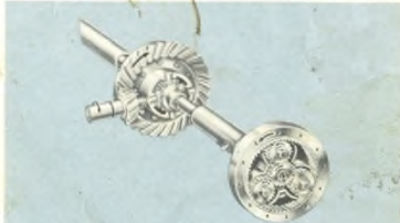
Наличие колесной передачи снижает нагрузку деталей силовой передачи и дает возможность увеличить дорожный просвет.
