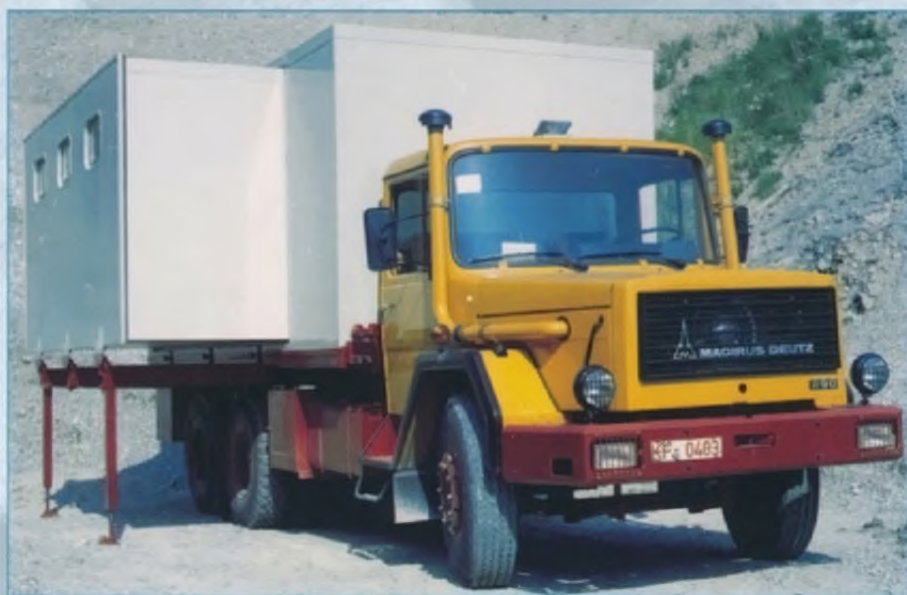
Werks-Kundendienst: Speziell ausgerüstet für die Reparatur der Magirus-Technik waren die ausziehbaren Werkstattaufbauten, die Rhein-Bayern lieferte.
