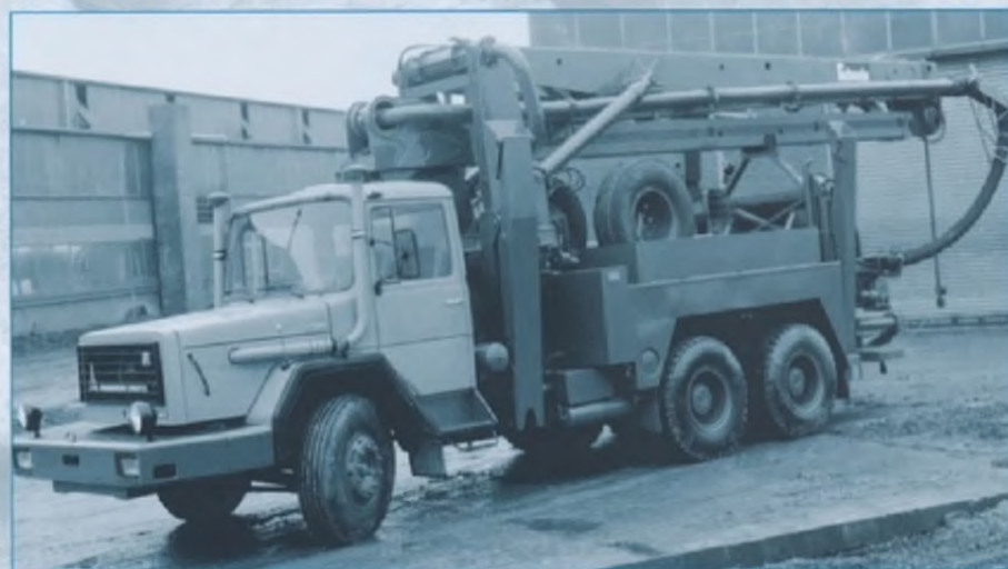
▲ Verlängerte Nase: Als Basis für die Betonpumpen der Firma Scheele diente ebenfalls das Kipperfahrgestell.
