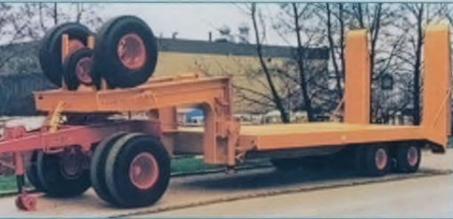
Mitgelieferte Dolly-Achsen ermöglichten eine universelle Nutzung der Kögel-Auf- lieger.
