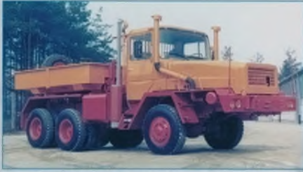
Ein Teil der 60 Faun-Zugmaschinen war mit einer Ballastbrücke ausgerüstet.
