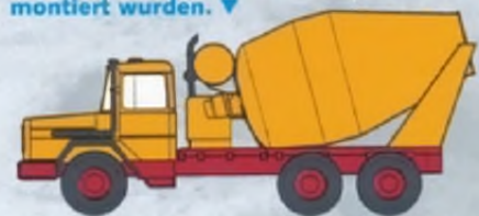
Vögele lieferte zahlreiche Mischaufbauten mit 6,5 m 3 Fassungsvermögen, die auf das M 290 D 26 K-Fahrgestell montiert wurden. ▼
