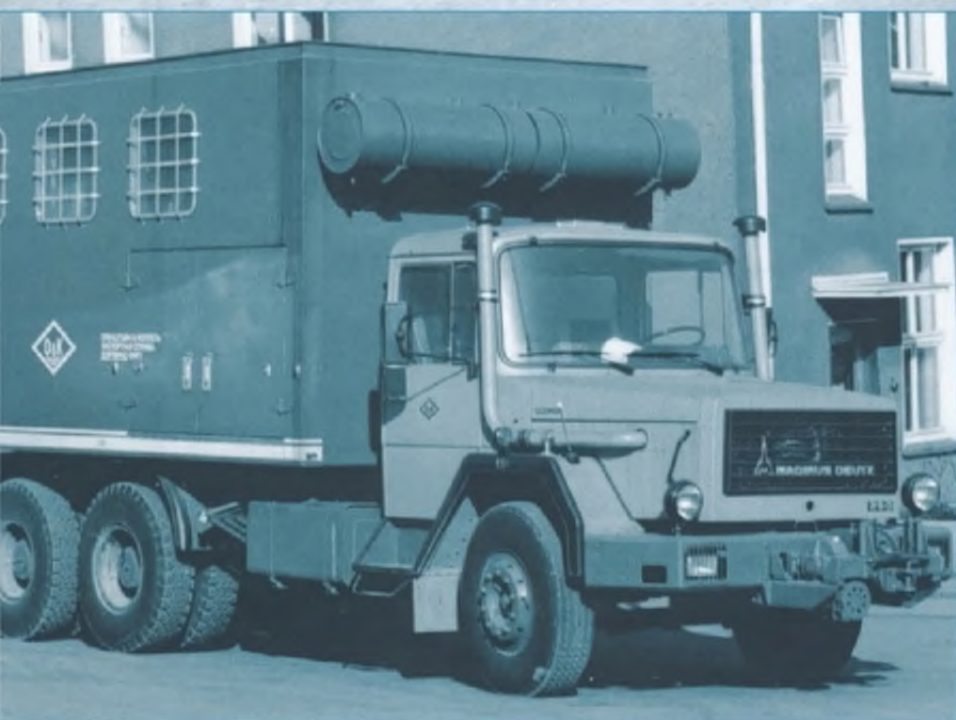
Werks-Kundendienst: Speziell ausgerüstet für die Reparatur der Magirus-Technik waren die ausziehbaren Werkstattaufbauten, die Rhein-Bayern lieferte.
