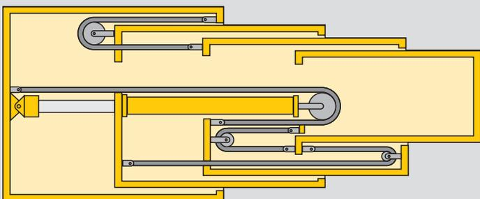
**Проверенная в работе гидромеханическая система телескопирования**
