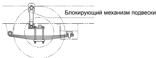
Листовая рессора переменного сечения и блокирующий механизм подвески (опция)
