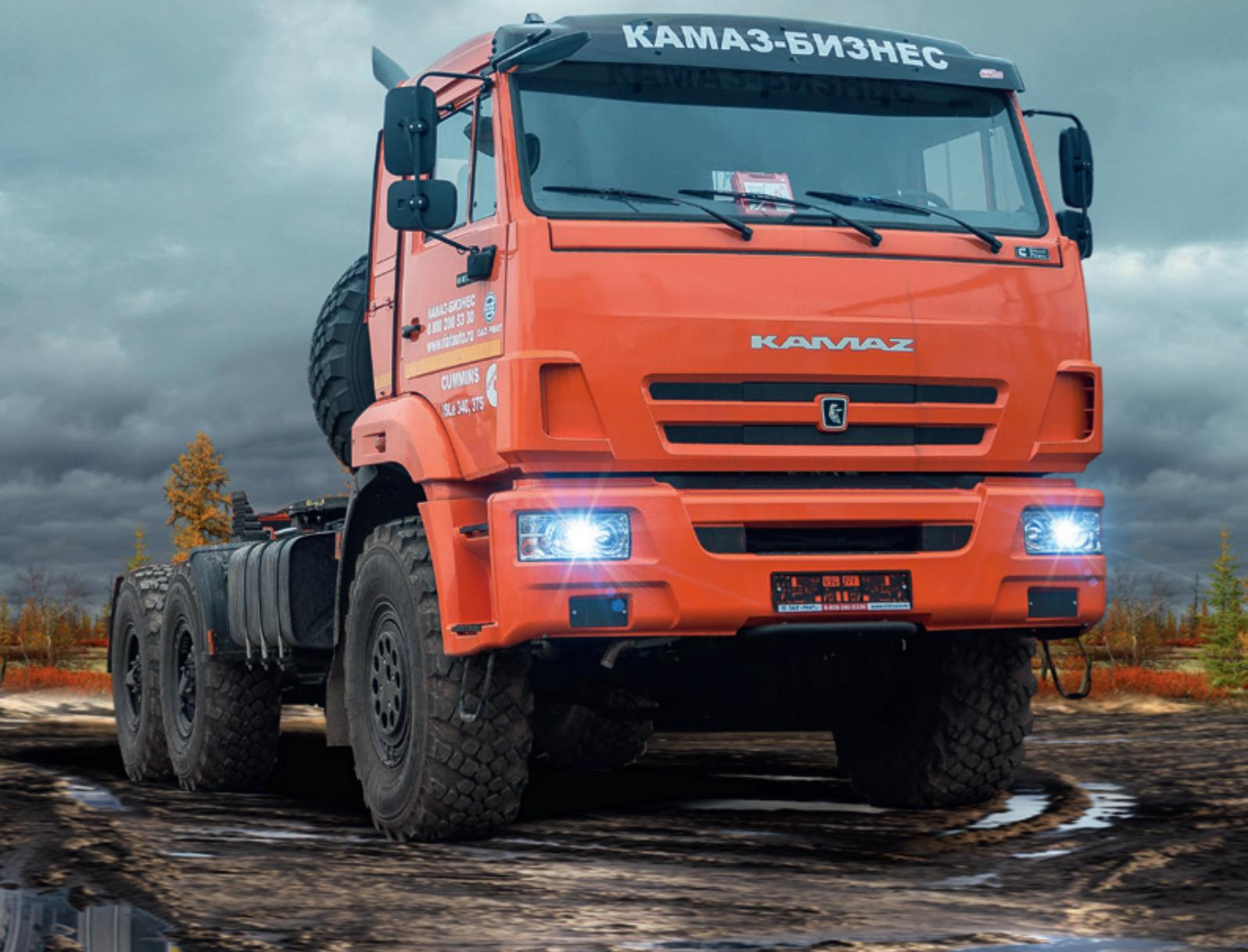
Повышенная проходимость по сравнению с аналогами с колесной формулой 6x6 благодаря повышенной энерговооруженности за счет использования мощной силовой установки с двигателем Cummins ISLe-C340 мощностью 340 л.с. и надежной девятиступенчатой КПП ZF-9S1310
