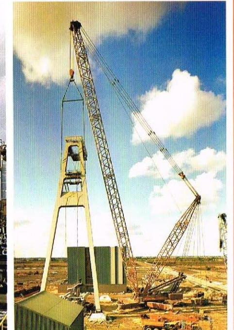
GOTTWALD AK 680, 650/850 t Tragfähigkeit
