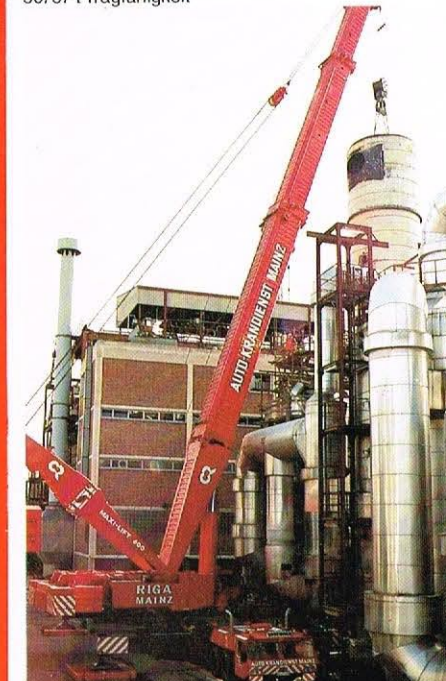
GOTTWALD AMK 400-93, 400/500 t Tragfähigkeit
