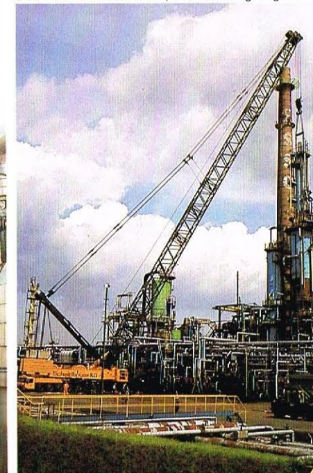
GOTTWALD AK 850, 800/850 t Tragfähigkeit
