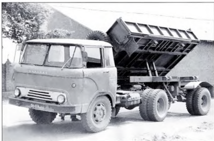
▲ «Колхида» КАЗ-608 с самосвальным полуприцепом АСП-7, грузоподъемностью 7 тонн, производства Бобруйского завода нестандартного оборудования
