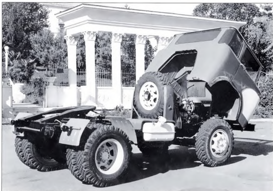
▲ Запасное колесо на опытном тягаче установлено за кабиной по центру, но на серийных КАЗ-608 оно будет смещено к правому борту
