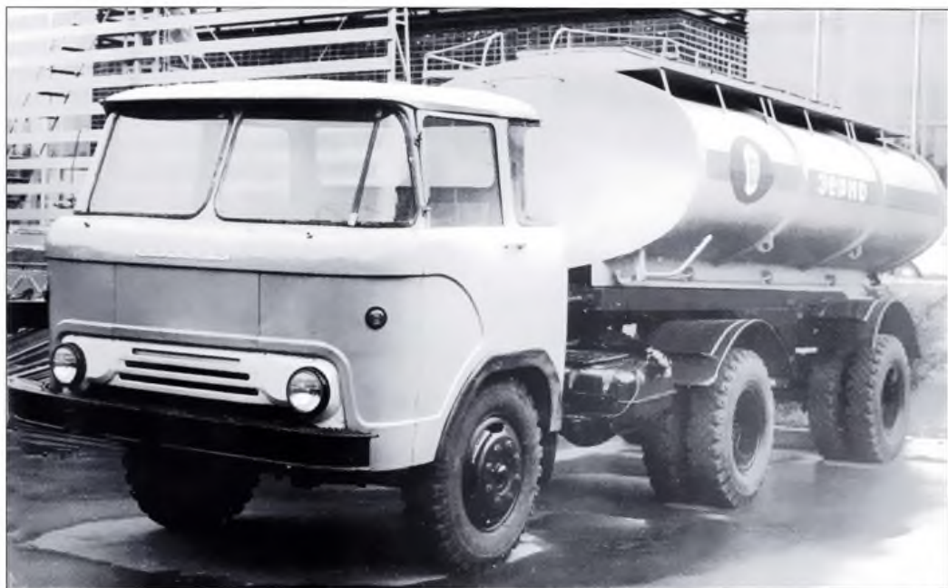
^ Седельный тягач КАЗ-608 поздних выпусков со специальным полуприцепом ТАС-34 для бестарной перевозки зерна, на выставке на ВДНХ СССР в 1971 году. Фото А. Новикова
