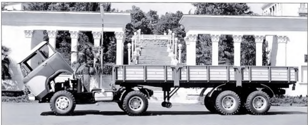
▲ Автопоезд в составе «Колхиды» КАЗ-608 и полуприцепа КАЗ-717 представлял внушительное зрелище, но был не очень пригодным к интенсивной эксплуатации на междугородных маршрутах
