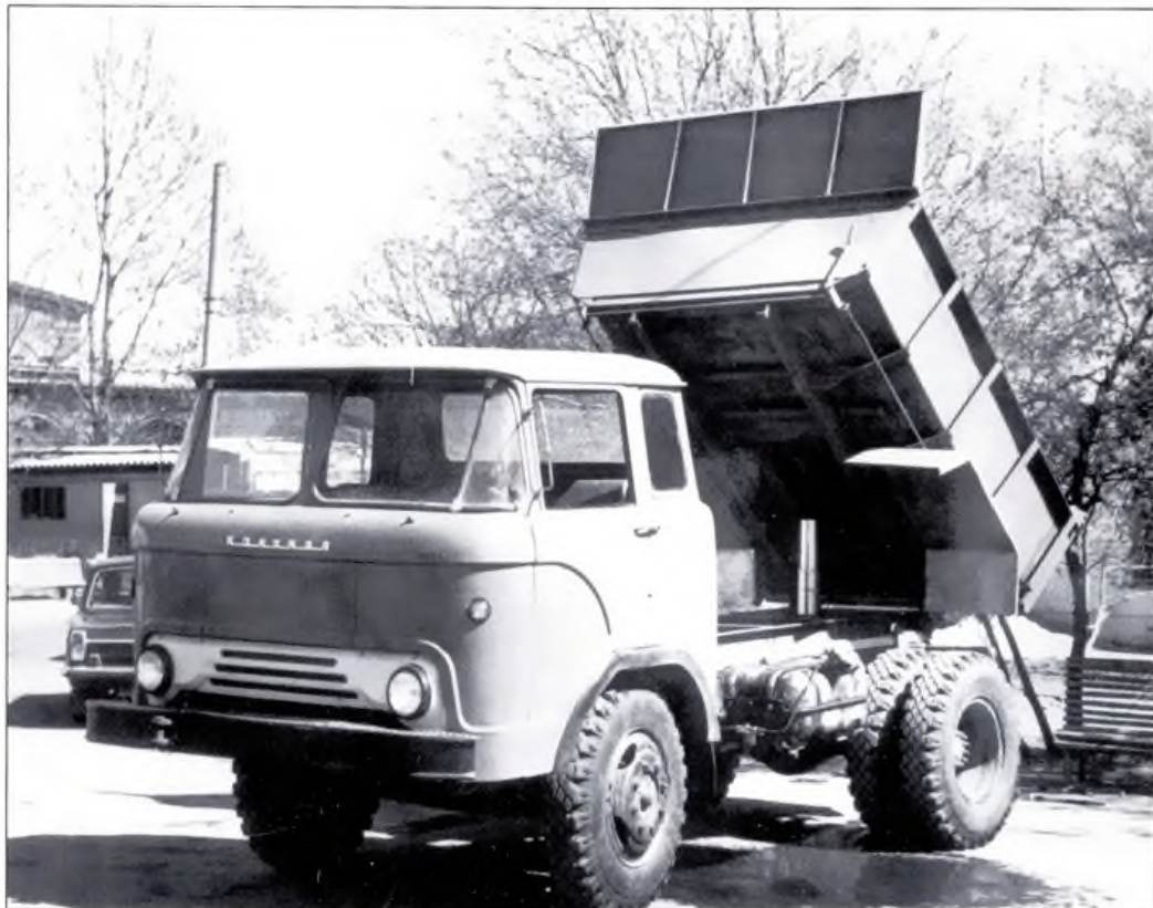
▲ Самосвал на шасси седельного тягача КАЗ-608 изготавливался серийно на Тосненском ремонтном заводе в Ленинградской области. Фото А. Гонтареева
