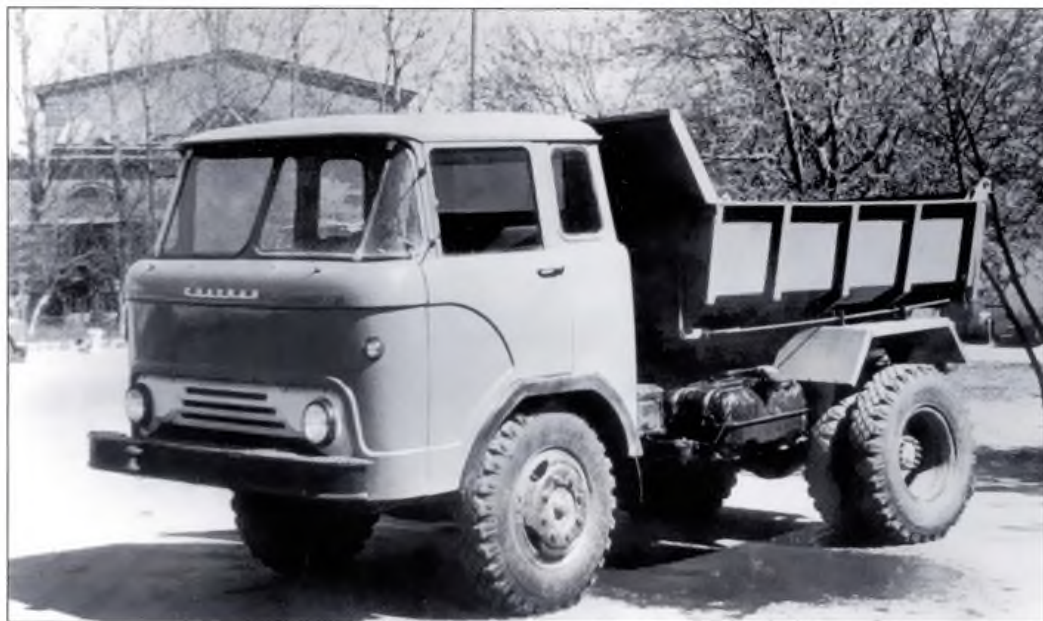
▲ Самосвал на шасси седельного тягача КАЗ-608 изготавливался серийно на Тосненском ремонтном заводе в Ленинградской области. Фото А. Гонтареева
