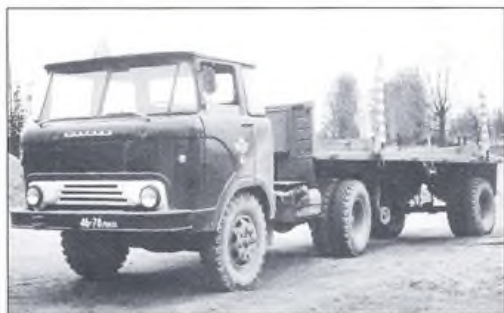
▲ Два автомобиля КАЗ-608 выпуска после 1968 г. с одной и той же литовской автобазы с полуприцепами ОДАЗ-885, переделанными под перевозку строительных железобетонных плит. Фото Л. Суславичюса ▲
