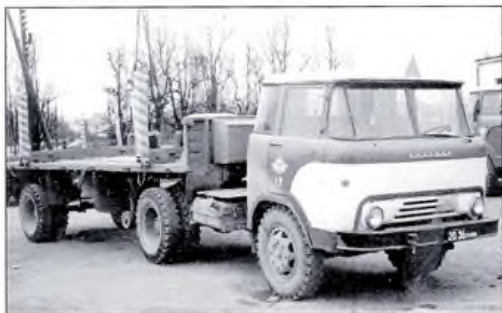
▲ Два автомобиля КАЗ-608 выпуска после 1968 г. с одной и той же литовской автобазы с полуприцепами ОДАЗ-885, переделанными под перевозку строительных железобетонных плит. Фото Л. Суславичюса ▲
