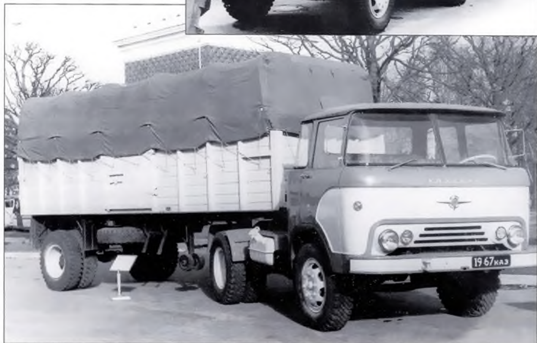
КАЗ-608 «Колхида» с полуприцепом ОДАЗ-898 для народнохозяйственных грузов с кузовом увеличенного объема. В Одессе этот полуприцеп выпускался всего один год (с 1965 по 1966 г.). Фото А. Новикова
