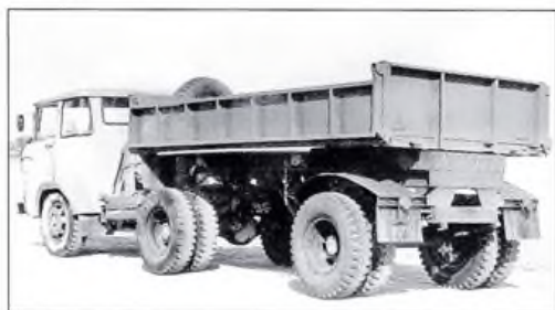
▲ «Колхида» КАЗ-608 с самосвальным полуприцепом АСП-7, грузоподъемностью 7 тонн, производства Бобруйского завода нестандартного оборудования
