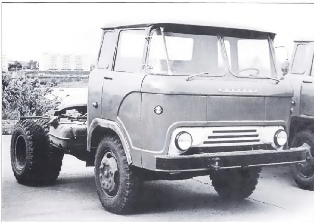
▲ Серийный автомобиль КАЗ-608. С 1968 г. на тягач перестали устанавливать противотуманные фары и панорамные стекла в задних стойках кабины
