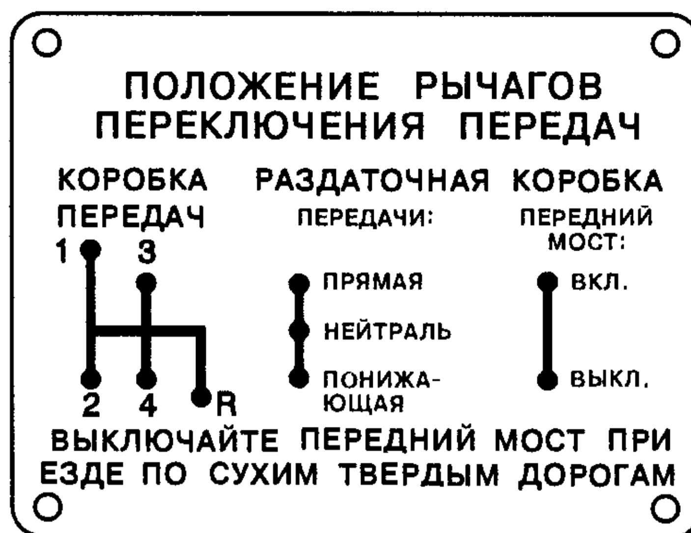
Рис. 4. Схема положений рычага коробки передач и рычагов раздаточной коробки
