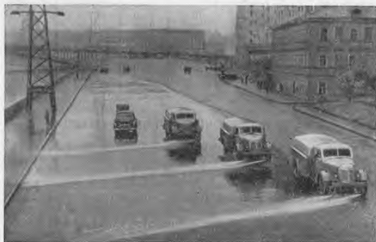
Рис. 18. Поливочно-моечные машины ПМ-8 на мойке дорожного покрытия.
