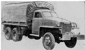
Фиг. 2. Общий вид автомобиля Студебекер US 6×6
