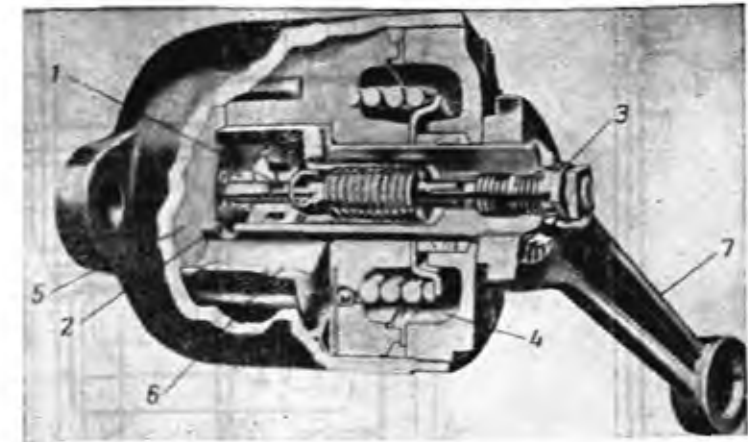
Фиг. 39. Амортизатор: 1 — калиброванное отверстие; 2 — клапан; 3 — головка клапана; 4 — дополнительный резервуар; 5 — рабочая камера; 6 — крыльчатка; 7 — рычаг
