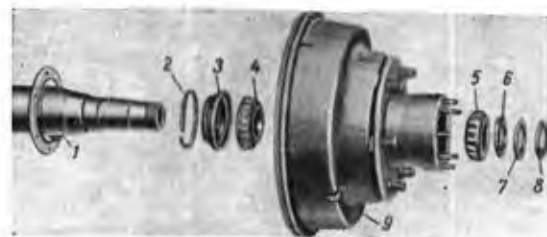
Фиг. 25. Детали ведущего колеса:
