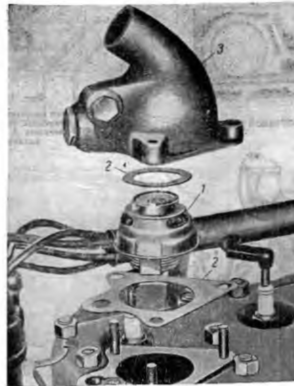
Фиг. 6. Детали термостата: 1 — термостат; 2 — прокладки; 3 — верхний патрубок системы охлаждения
