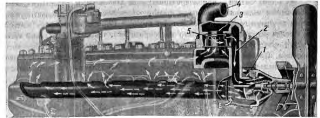
Фиг. 5. Схема работы термостата: 1 — водяной насос; 2 — трубопровод циркуляции при закрытом рабочем клапане термостата; 3 — клапан термостата; 4 — верхний выходной патрубок системы охлаждения; 5 — выпускные отверстия термостата при закрытом рабочем клапане
