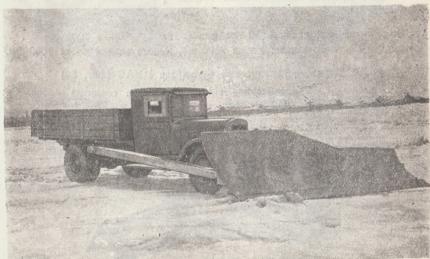
Фиг. 29. Автомобильный одноотвалный снегоочиститель НИАС.
