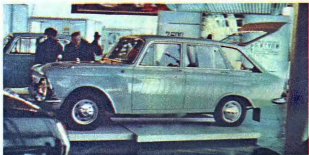
ИЖ-2125 имеет почти такие же габариты, как седан «Москвич-412», сухой вес автомобиля на 35 кг больше, чем у базовой модели.
