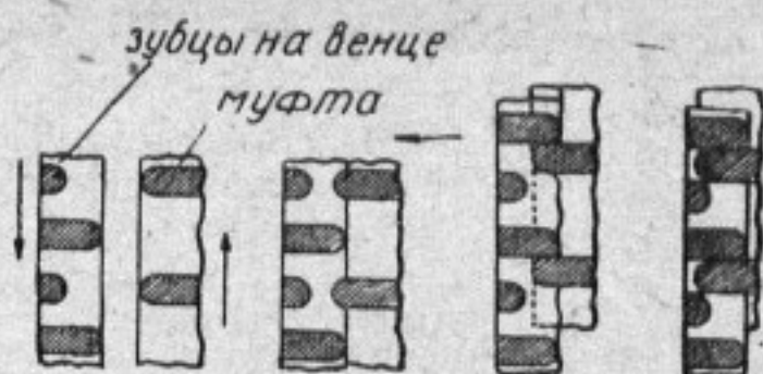
Рис. 6. Схема действия муфты переключения
