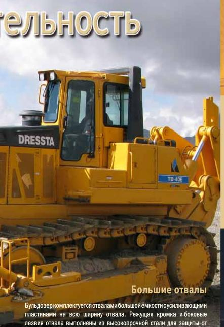
Для достижения большей универсальности выполняемых работ, отвал бульдозера может оснащаться гидравлическим перекосом или
