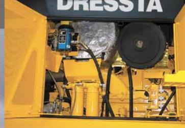
Современный двигатель CUMMINS QSK19 с электронной системой подачи топлива типа «common rail» соответствует требованиям норм по выхлопным газам Tier 3, что обеспечивает высокую производительность, минимальные эксплуатационные расходы и длительное время безотказной работы.
