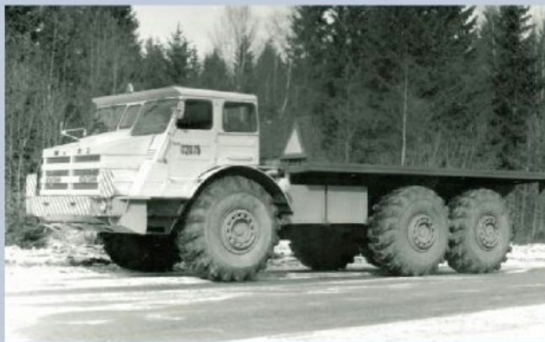
Первоначальный вариант МоАЗ-74111 с безбортовой платформой
