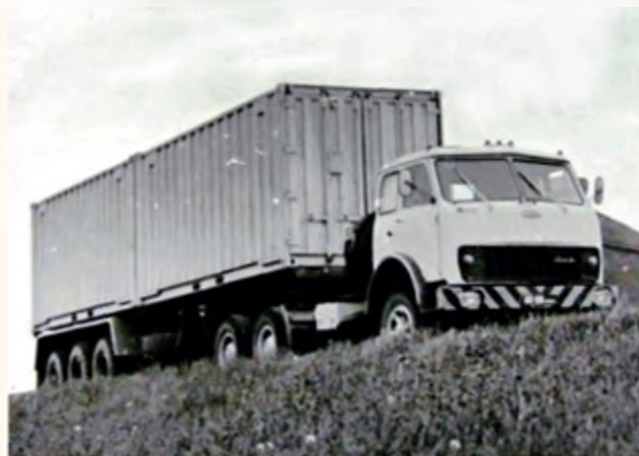
В 1976 году все выпускаемые МАЗом грузовики модернизировали. Трехосники получили измененное оформление передней части кабины, а фары были перенесены в бампер
