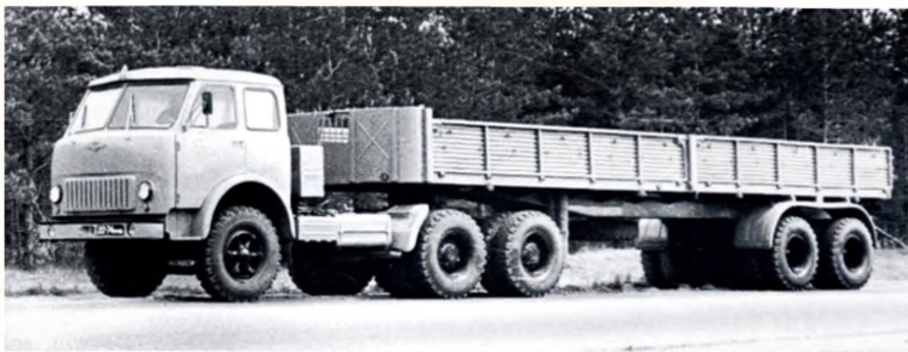
Одновременно с трехосным бортовым автомобилем на заводе разработали и трехосный седельный тягач, получивший обозначение MAZ-515. Специально для него был спроектирован бортовой полуприцеп MAZ-944, рассчитанный на перевозку 25 т груза
