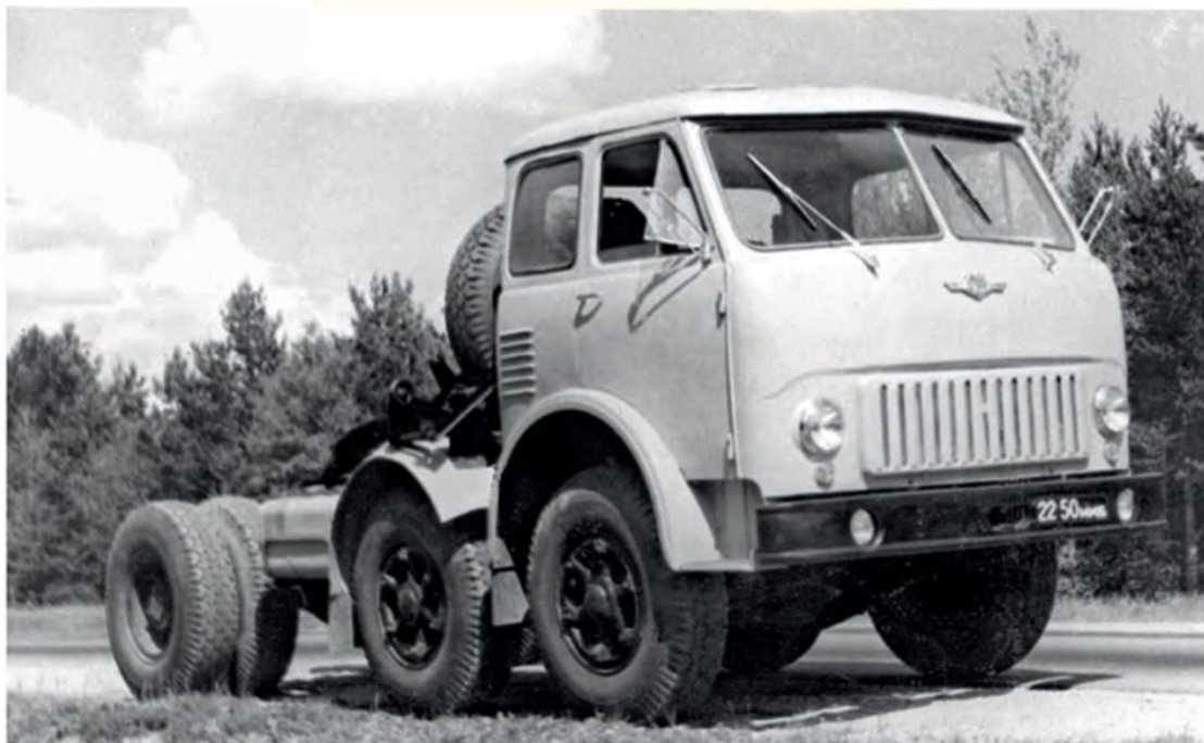
В поисках возможности увеличения грузоподъемности на МАЗе разработали трехосный седельный тягач с двумя передними управляемыми осями
