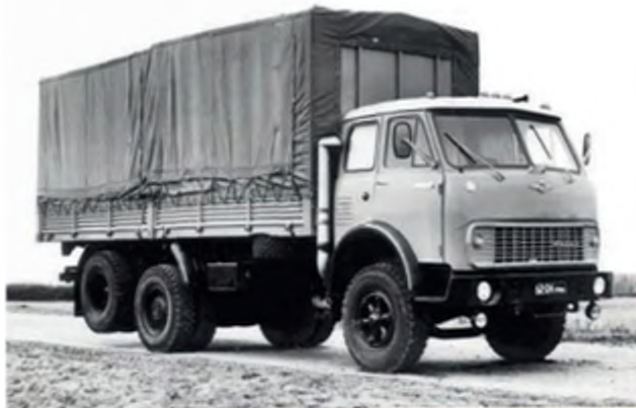
В 1976 году все выпускаемые МАЗом грузовики модернизировали. Трехосники получили измененное оформление передней части кабины, а фары были перенесены в бампер
