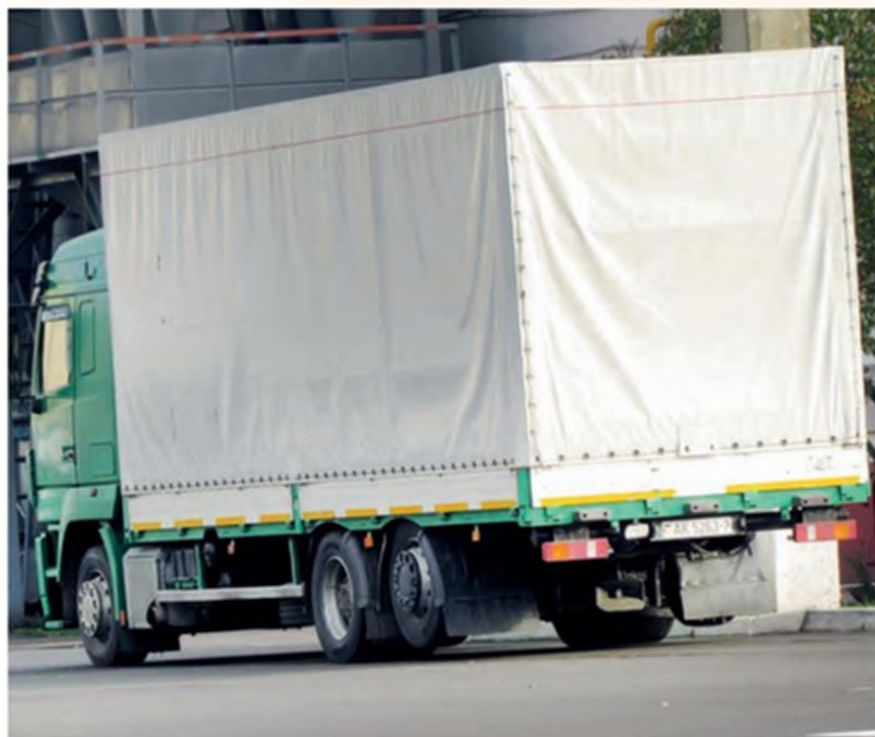
Шинский завод продолжает производство трехосных грузовиков с поднятой задней осью. На снимке - MAZ-6310 в незагруженном состоянии: задняя ось поднята
