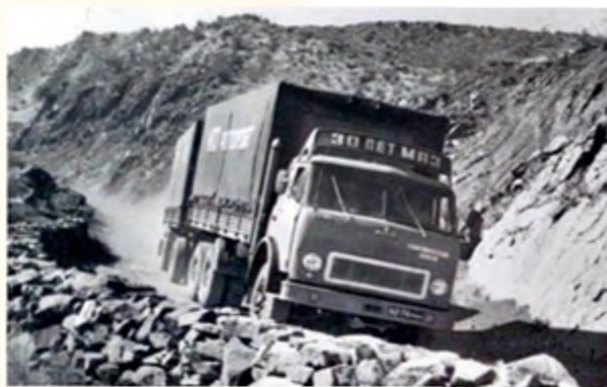
Трехосная схема и привод на две задние оси у MAZ-514 и MAZ-515 наилучшим образом отвечали их применению в условиях низкокачественных дорог нашей страны
