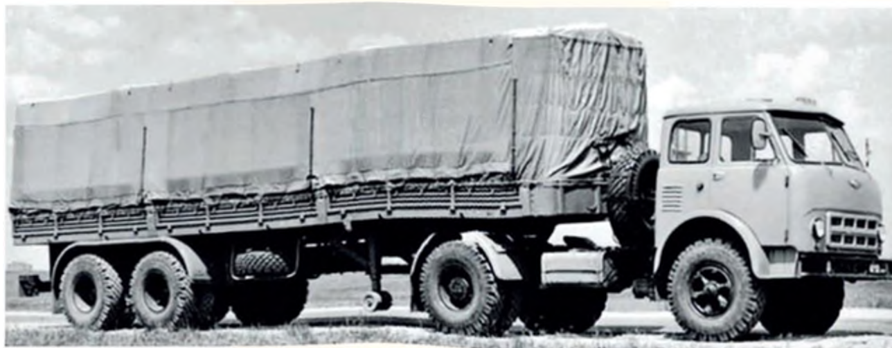
В декабре 1969 года завершились приемочные испытания МАЗ-504В, который вместо 6-цилиндрового дизеля ЯМЗ-236 получил более мощный 8-цилиндровый ЯМЗ-238. Одновременно такие двигатели адаптировали и для трехосных автомобилей завода
