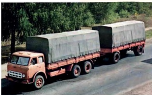
МАЗ-516 с прицепом МАЗ-886Б грузоподъемностью 7 т
