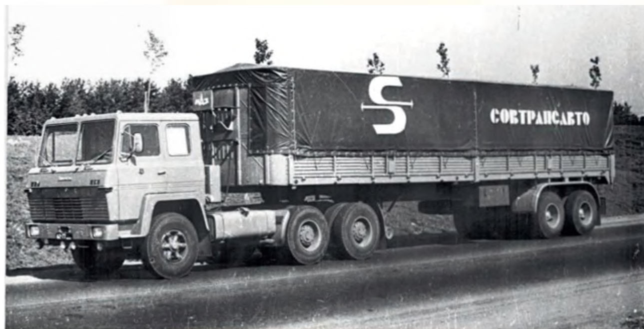
Добившись повышения грузоподъемности своих тягачей, завод взялся за повышение их комфортабельности. На снимке – трехосный магистральник с опытным вариантом новой кабины, от которого впоследствии отказались.
