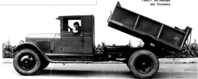
рычага отводил запорный крюк из зацепления с коробчатым сварным кронштейном. Зад кузова начинал опускаться благодаря смещению центра тяжести по отношению к упорным роликам, поворачиваясь вокруг оси передних роликов, а две расположенные по бокам направляющие подъемные тяги заставляли кузов откатываться назад.
