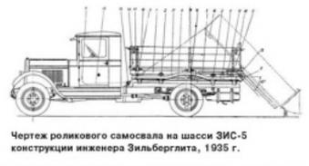
Чертеж роликового самосвала на шасси ЗИС-5 конструкции инженера Зильберглита, 1935 г.
