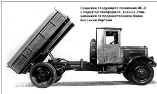
Самосвал следующего поколения ЯС-3 с поднятой платформой, внешне отличающийся от предшественника более высокими бортами
