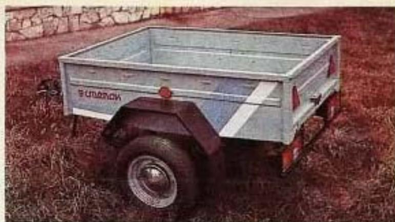
Пятидверный универсал ЗАЗ-1105 практичен и достаточно вместителен [фото слева]. Прицеп «Степок». В его конструкции целиком использована задняя подвеска ЗАЗ-968М.
