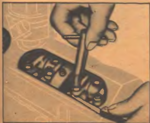
Проверка теплового зазора в приводе клапанов
