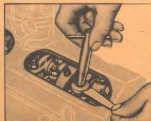
Регулировка теплового зазора в приводе клапанов
