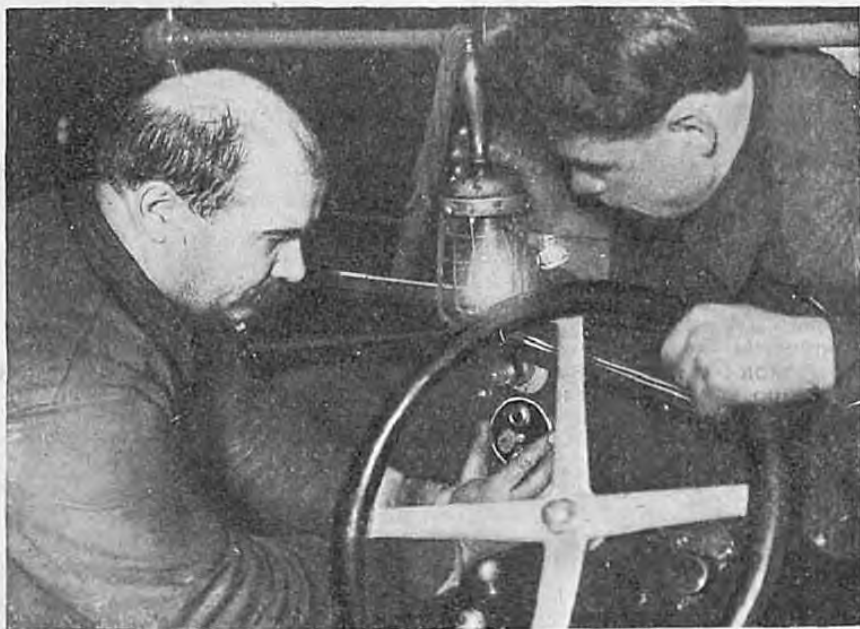
На заводе „Спартак“. Установка электрического оборудования на арматурной доске
