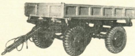
Прицеп-самосвал МАЗ-847 разработан на шасси прицепа МАЗ-5207В и предназначен для работы в составе автопоезда с автомобилем-самосвалом МАЗ-511.
