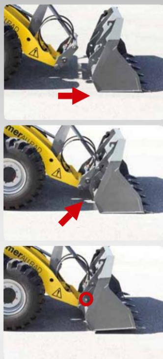
Параллельный подъем обеспечивает баланс при работе с ковшом или паллетными вилами.
