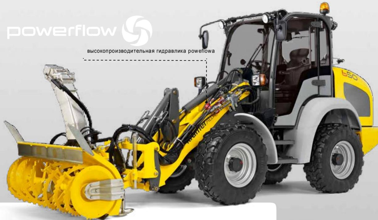
Рабочая гидравлика позволяет осуществлять точные операции с минимальной затратой сил и низким уровнем шума в кабине. Стандартная 3-я гидрофункция с непрерывным действием позволяет более эффективно работать с навесным оборудованием.
