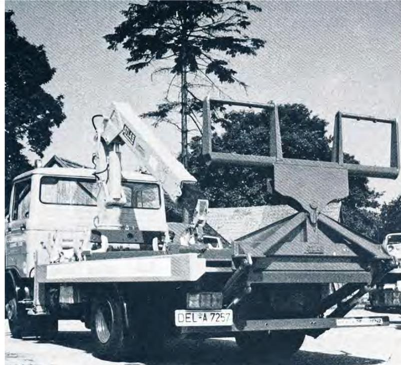
Durch die ATLAS-Bergungs- und Abschleppkombination ist es jetzt möglich, mit nur einem Abschleppfahrzeug, das ein mittlerer Lkw sein kann und von einer Person bedient wird, zwei Unfallfahrzeuge zur gleichen Zeit abzuschleppen und dadurch die Unfallstelle schnell zu räumen.
