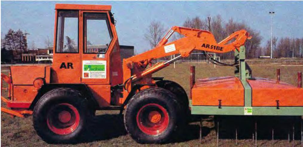
Das Bohrgerät diente zur Regeneration strapazierter Rasenflächen. Der Radlader AR 51BE wurde mit einer zusätzlichen elektronischen Steuerung zur automatischen Positionierung des Werkzeuges und Radladers ohne weiteren Eingriff durch den Fahrer ausgestattet.
