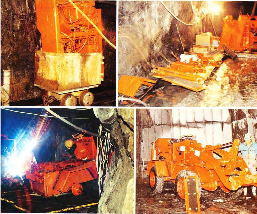
Schieferproduzent Rathscheck & Söhne setzte Atlas Radlader zum Abbau von Schiefer ein. Dazu wurden die Baugruppen einzeln Untertage verbracht und dort montiert.
