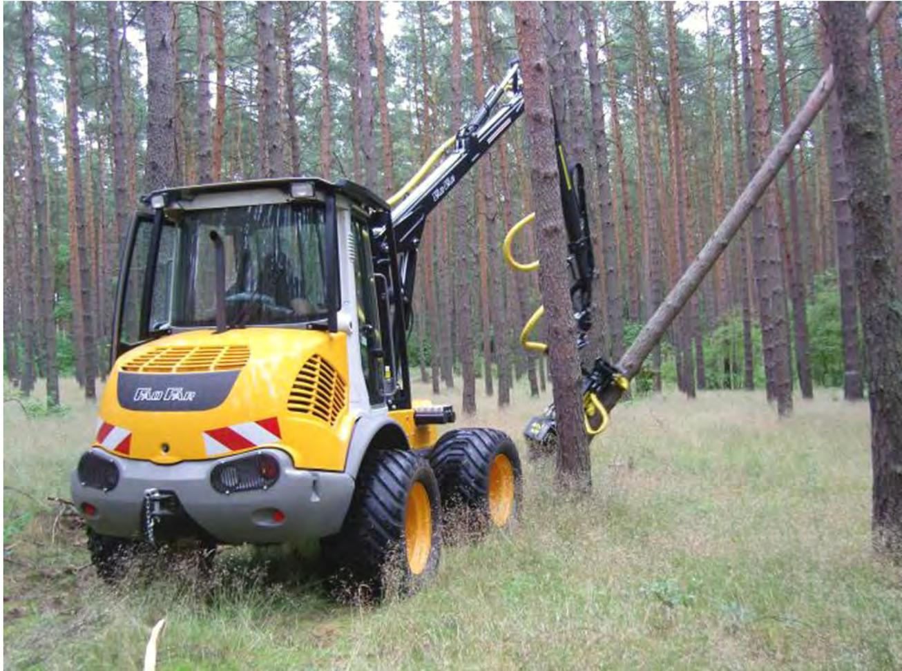
FAOFAR Harvester auf Basis des AR 75 S. Das Gerät wird von uns ohne Hubwerk ausgeliefert.
