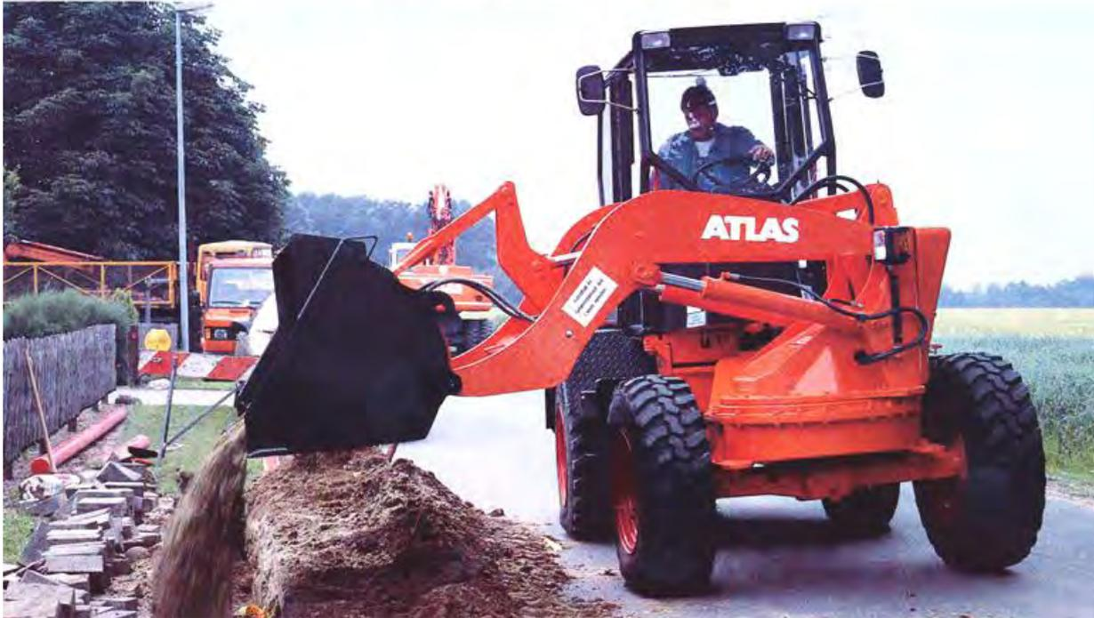
Im Kabelbau, beim Eisenbahnbau innerhalb des Gleiskörpers, im innerstädtischen Straßenbau und beim Verfüllen von Kanal-Gräben geht es häufig sehr beengt zu. Hier empfiehlt sich der Einsatz eines Schwenkladers.
