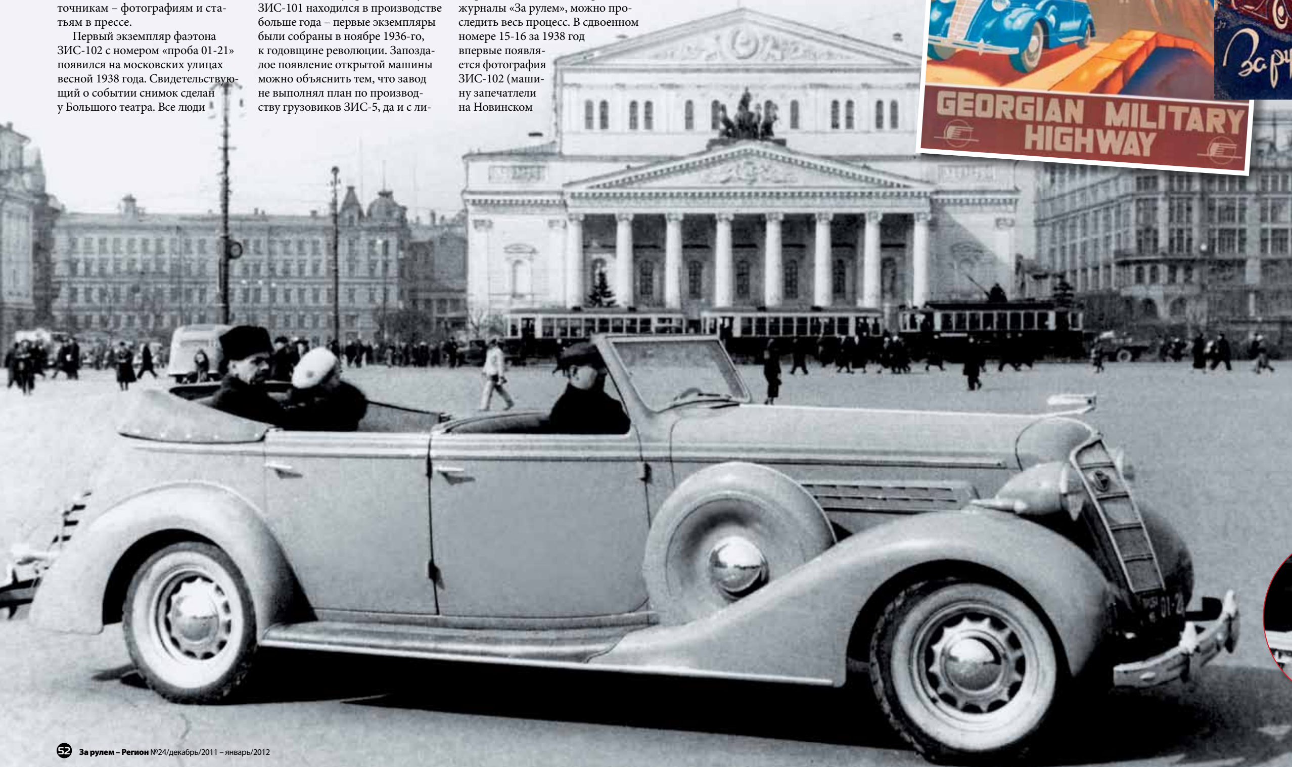
Вариант с кузовом кабриолет – полноценные стекла с рамками, на уровне задних сидений отсутствуют окна
