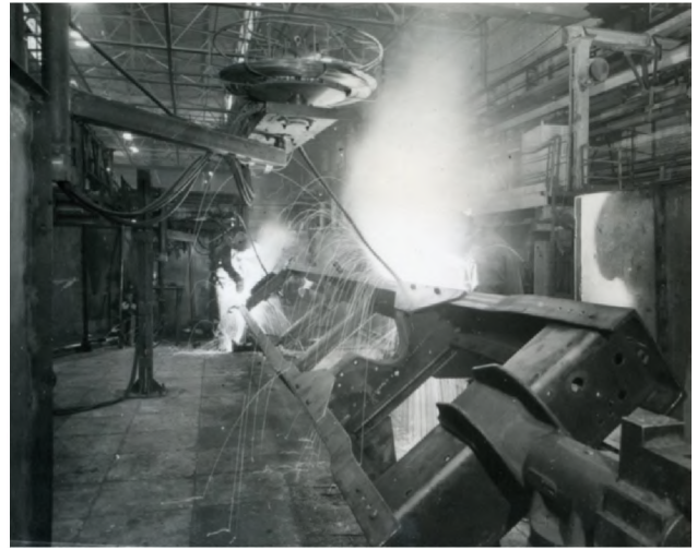
Полуавтоматическая сварка рам в среде углекислого газа на участке рам рамно-кузовного корпуса. 1967 г.
