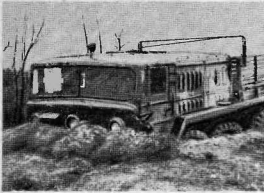
Различные моменты испытаний тягача. Обратите внимание на верхний снимок: МАЗ-535А легко преодолевает участок очень плохой дороги, имея на бунксире ЗИУ-157.
