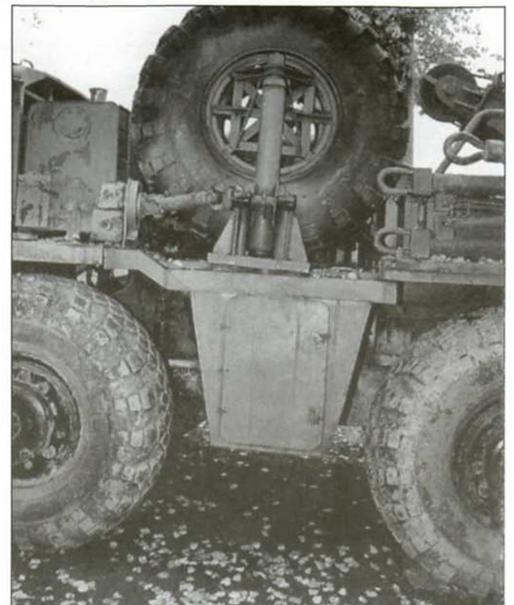
*Эвакуаторы КЭТ-Т строились на базе тягачей МАЗ-537Г. Данная машина сочетает черты тягача среднего выпуска и поздней постройки: кожух топливных баков отсутствует, что характерно только для машины очень поздней постройки.*
