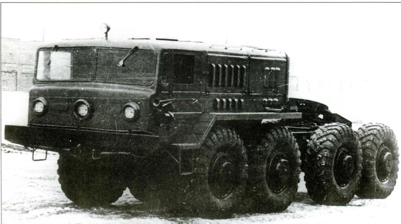
*В одно время с тягачом-грузовиком МАЗ-535А разрабатывался «чистый» тягач МАЗ-535В. В кормовой части машины смонтировано буксировочное устройство, которое на Западе изрядно именуют «fifth wheel», пятое колесо. Вообще-то, у тягача МАЗ-535А уже имелось минимум восемь колес, значит пятых колес на МАЗ537 стало быть пара! На снимке - тягач раннего выпуска с тремя фарами.*
