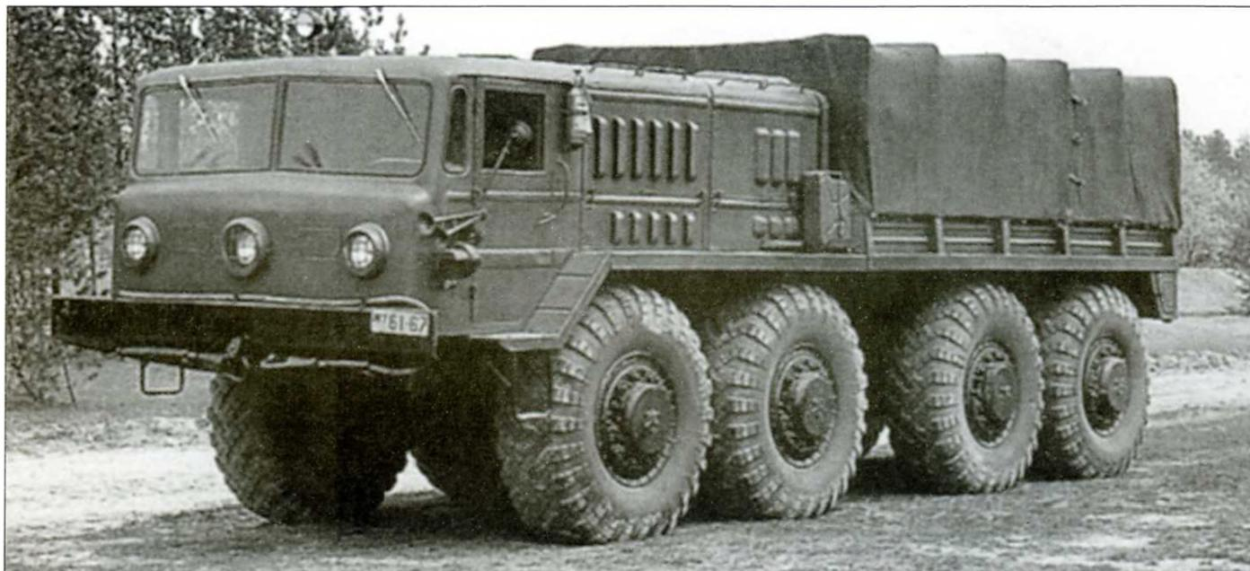
*МАЗ-535А оснащался кузовом для перевозки людей и грузов, в кузове также был уложен балласт. Машины ранней постройки снабжались тремя фарами в лобовой стенке кабины, на центральную фару при необходимости ставилась инфракрасная насадка. Вентиляционные лючки ниже лобовых стекол кабины МАЗов то появлялись, то исчезали на протяжении всего периода серийного выпуска тягачей.*
