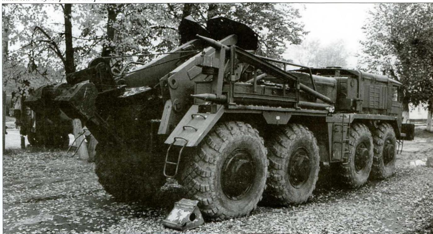
Буксировка тягачом КЭТ-Т тягача МАЗ-537 на большое расстояние. Тягач КЭТ-Т способен буксировать прицеп массой до 32 т со скоростью 8 км/ч по пересеченной местности и со скоростью 50 км/ч по шоссе.
