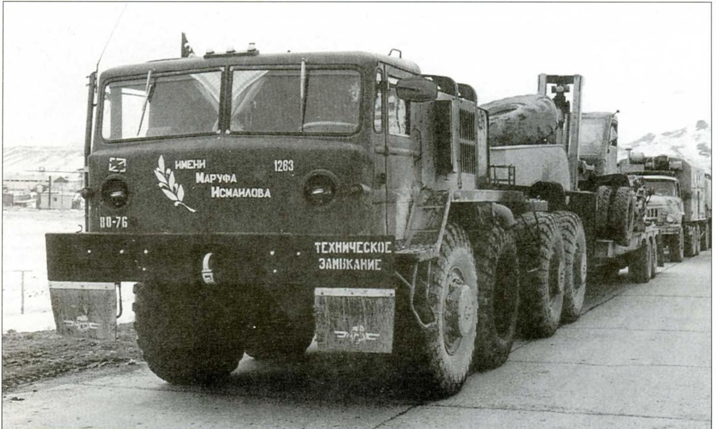
Три сямка тягачей МАЗ-537 в Афганістане. На фото вверху - тягачі МАЗ-537Г з полуприцепами, загрузеными танкамі Т-62. Обратіте вніманіе, что у машіні на среднем и нижнем фото сняты капоты моторов для лучшего охлаждения.
