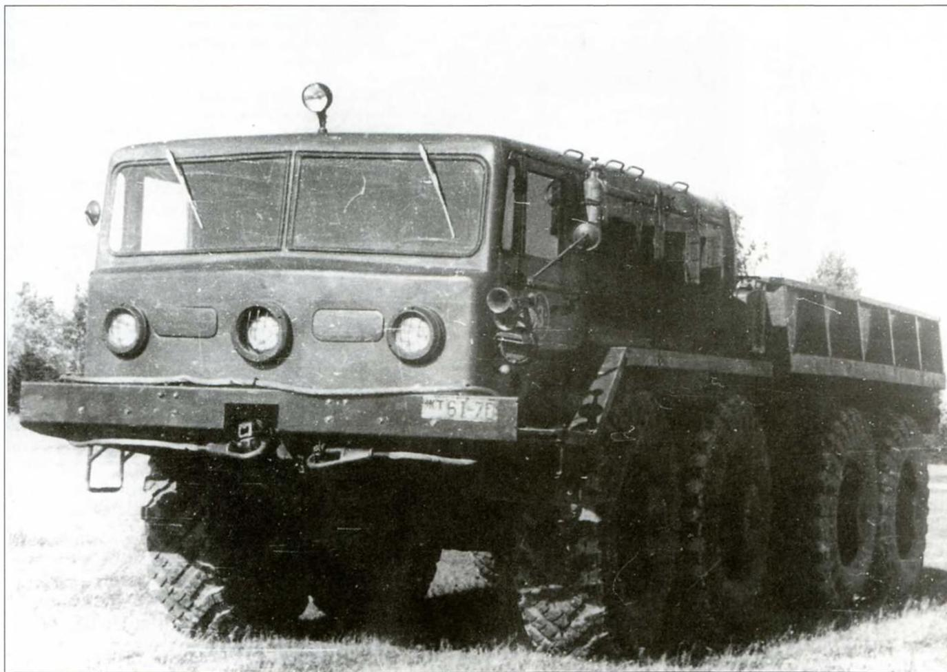
*На тягаче МАЗ-537А за моторным отделением монтировался кузов. На снимке хорошо видны основные внешние отличия МАЗ-535 от МАЗ-537: иные вентиляционные жалюзи в стенках моторного отделения, на МАЗ-535 вентиляционные щели располагались вертикально в один ряд, на МАЗ-537 - только в один ряд, вертикально. Три фары имелись лишь у тягачей МАЗ-537 ранней постройки.*
