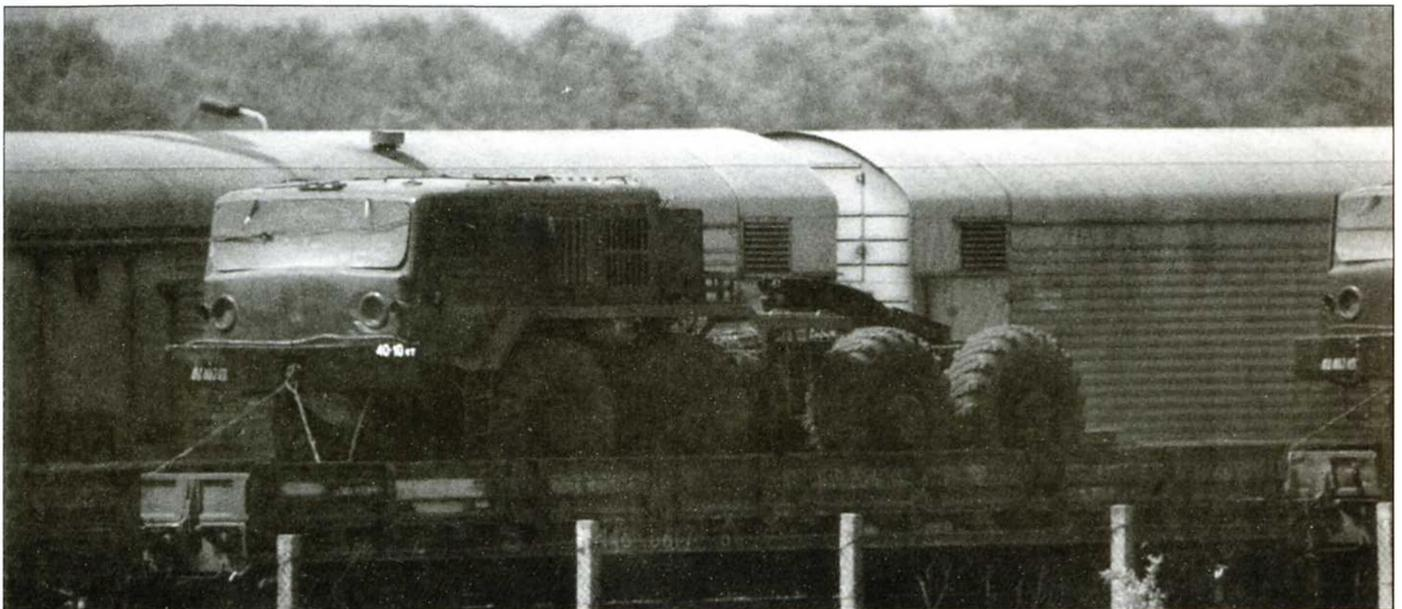
*При перевозке на большие расстояния по железной дороге остекление тягачей по возможности закрывали щитами - невоспитанные детишки любят пулять в стекла камушками. В кадр попал тягач, специально предназначенный для РВСН - МАЗ-537Э. За моторным отсеком установлен дизель-генератор и другая аппаратура специального назначения.*
