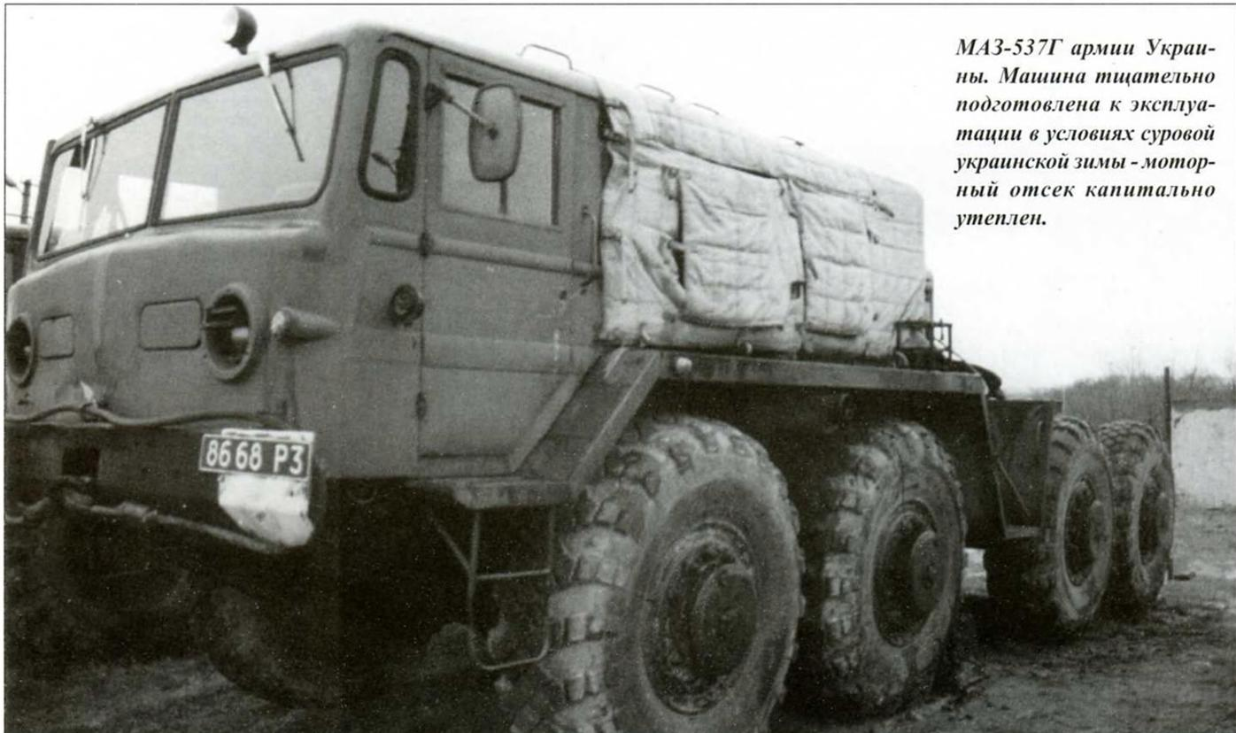
*МАЗ-537Г армии Украины. Машина тщательно подготовлена к эксплуатации в условиях суровой украинской зимы - моторный отсек капитально утеплен.*
