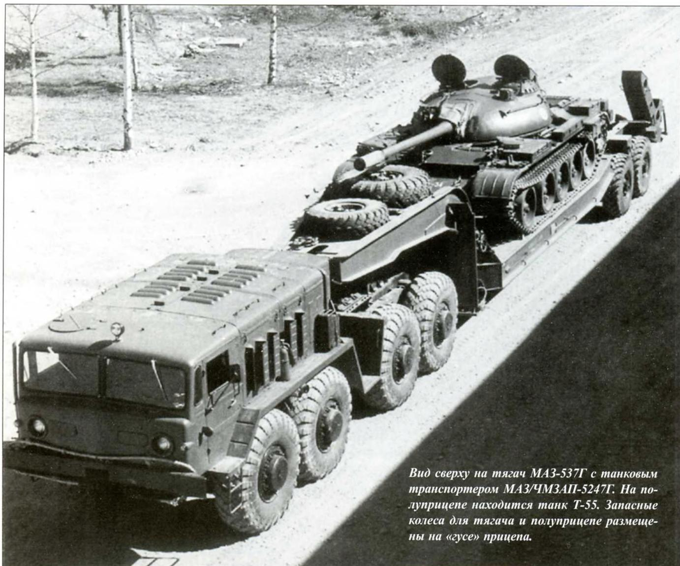
*Вид сверху на тягач МАЗ-537Г с танковым транспортером МАЗ/ЧМЗАП-5247Г. На полуприцепе находится танк Т-55. Запасные колеса для тягача и полуприцепа размещены на «гусе» прицепа.*
