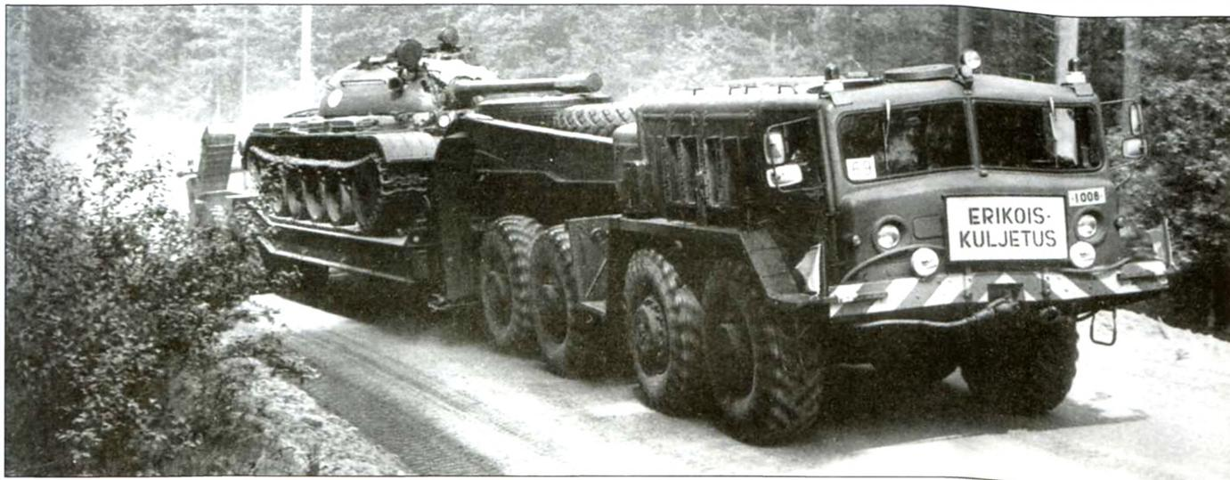
*Тягачи М13-537 эксплуатировались в вооруженных силах Финской республики, где их применяли для буксировки полуприцепов с танками Т-54/55 и Т-72.*
