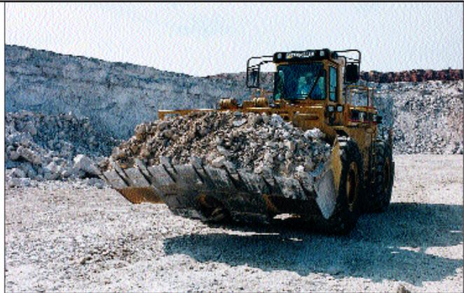
**Blockverlade-Maschine.** Um eine optimale Anpassung an eine Vielzahl von Blockverladeeinsätzen in Steinbrüchen sicherzustellen, gibt es diese Spezialmaschine in vier Versionen.
