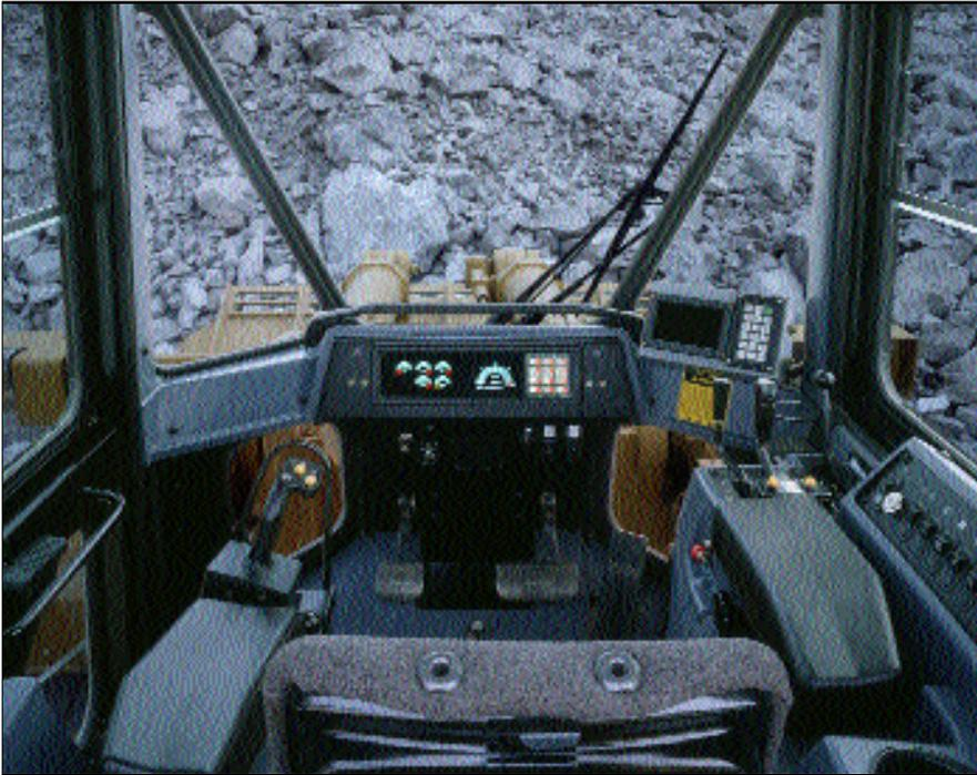
**Ergonomische Gestaltung.** Die großzügige Verglasung bietet freie Sicht nach allen Seiten. Ausreichende Ablagemöglichkeiten, Sonnenblende, Kleiderhaken, Becherhalter und Wischer-Intervallschaltung zählen zur Serienausstattung. Bei geschlossenen Türen und Fenstern liegt das Innengeräusch der schall- und vibrationsgedämmten Kabine unter 79 dB(A), gemessen nach EU-Richtlinie 86/882/EWG.
