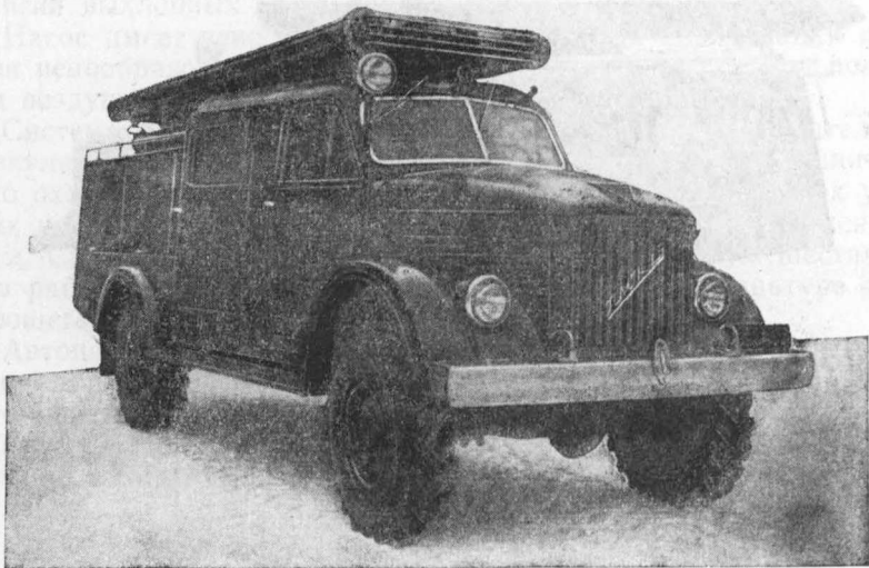
Рис. 1 Пожарная автоцистерна АЦП-20(63) на шасси ГАЗ-63
