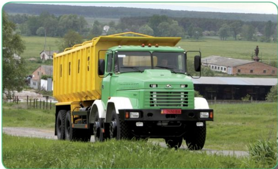
Самосвал КрАЗ-7133С4-030 «Еригадир» с 20-кубовым кузовом
