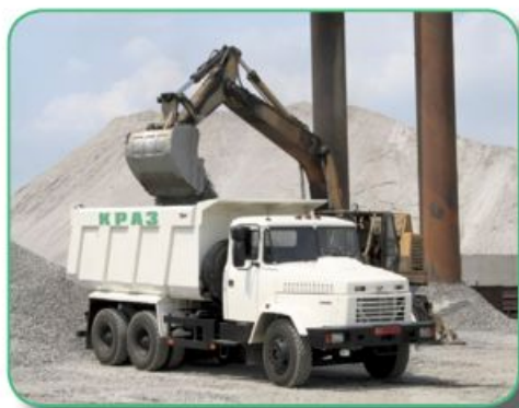
Самосвал КрАЗ-65055 «Прораб» на работе в карьере
