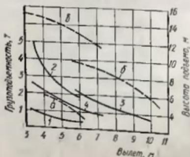
каждого положения существенно различны. При работе на выносных опорах грузоподъемность на 80% выше, чем без выносных опор.
