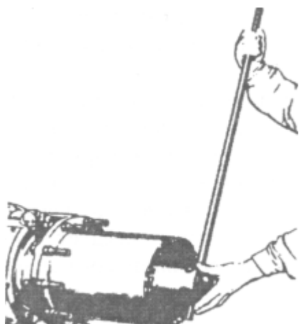
Рис. 10.6. Запрессовка внутреннего кольца наружного подшипника.
