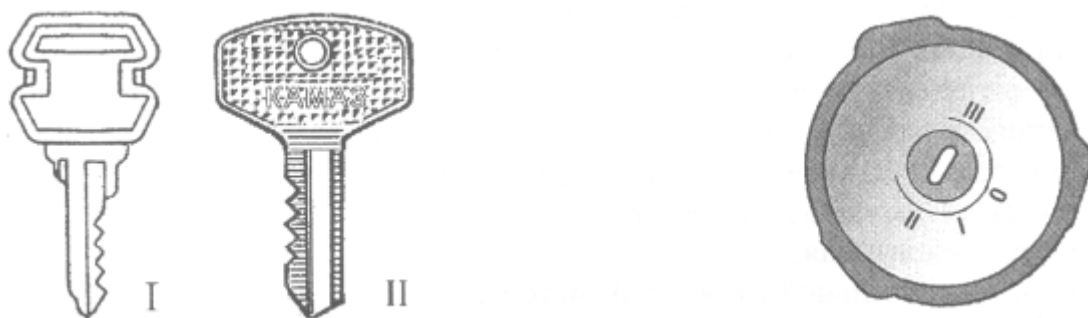
Рис. 6.11. Комплект ключей. Рис. 6.12. Выключатель приборов и стартера с противоугонным устройством.
