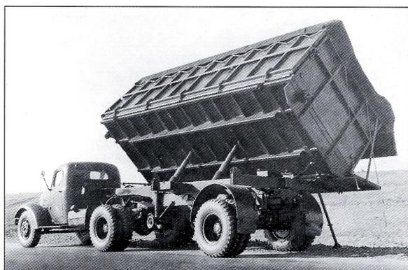
▲ Для опрокидывания кузова служили два трехзвенных телескопических гидроцилиндра
