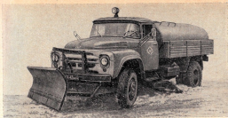
Рис. 48. Плужно-щеточное оборудование машины ПМ-130
