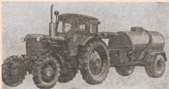
Рис. 1. Трактор-цистерна пожарная ТЦ-20(Т-40АМ), модель 165
