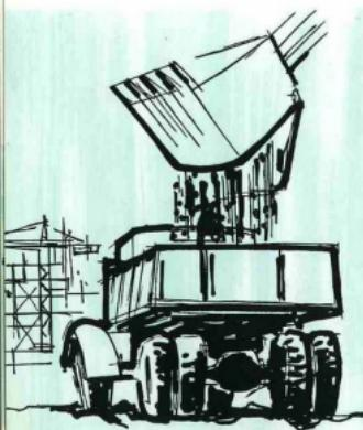
Автомобиль-самосвал МАЗ-205 грузоподъемностью 6 т оборудован металлической платформой емкостью 3,6 м<sup>3</sup>, опрокидывающейся назад до 50°. Опрокидывание кузова производится с помощью современного гидравлического подъемного механизма, приводимого в действие от двигателя.
