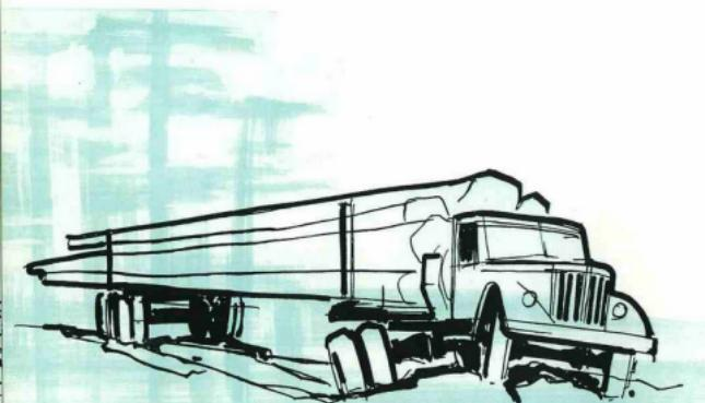
Автомобиль-лесовоз МАЗ-501 предназначен для перевозки бревен и леса в «хлыстах» длиной до 30 м. Он оборудован поворотным коником и приспособлением для буксировки прицепа-роллбука. Благодаря наличию двух ведущих осей, передней и задней, автомобиль обладает высокой проходимостью по лесным дорогам с грузом в 15 т.
