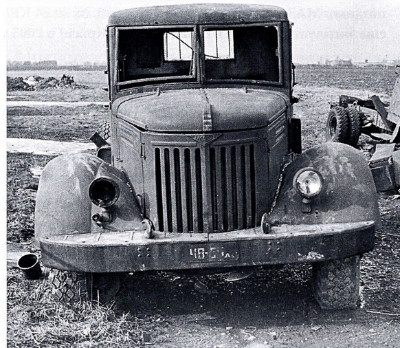
При обновлении автопарка на военном аэродроме Пуру с этой некогда АЦ-8-200 на шасси МАЗ-200 1954-1955 гг. выпуска демонтировали цистерну а шасси выволокли за пределы территории и бросили. Эстонская ССР, конец 1980-х гг.
