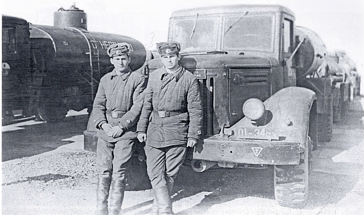
Серийные автоцистерны АЦ-8-200 позднего варианта на шасси МАЗ-200 1957-1959 гг. выпуска и их водители на службе в Советской армии. Применялись на военном аэродроме для доставки авиационного керосина ТС-1.
