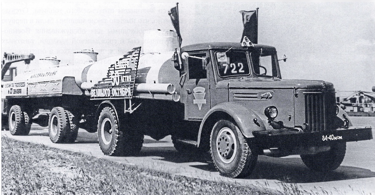
Еще один аналогичный усиленный автопоезд «Моспромтранса», где поздняя АЦ-8-200 установлена на шасси позднего МАЗ-200 (№ 84-40 мм), переоборудованного под дизель ЯАЗ-206А. Капот и передний бампер значительно наращены и выдвинуты вперед. Автопоезд подготовлен к выставке: на кабине закреплены флаги; на цистерне транспарант «В честь 50-летия Великого Октября»; на цистерне прицепа (полуприцеп ММЗ-584 с подкатной тележкой) надпись «Моспромтранс» и транспарант «Выполним план грузоперевозок к 27 декабря». Москва, лето 1967 г.
