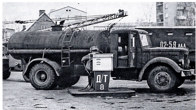
Экземпляр АЦ-8-200 с нестандартной горловиной и одним правым пеналом на шасси МАЗ-200 1955-1957 гг. выпуска в гражданской эксплуатации. Латвийская ССР, 1970-е гг.
